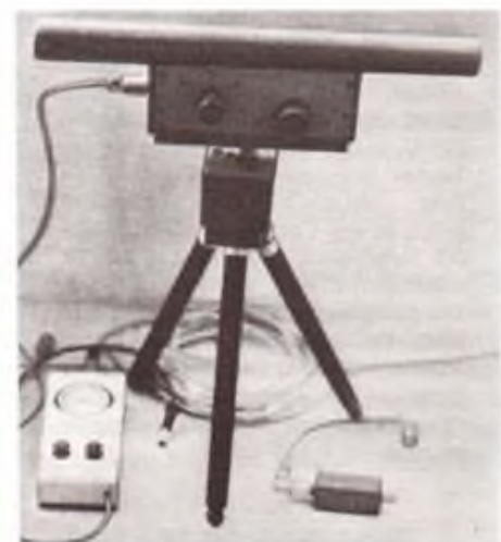
Bild 25: Musteraufbau der aktiven Ferritantenne
