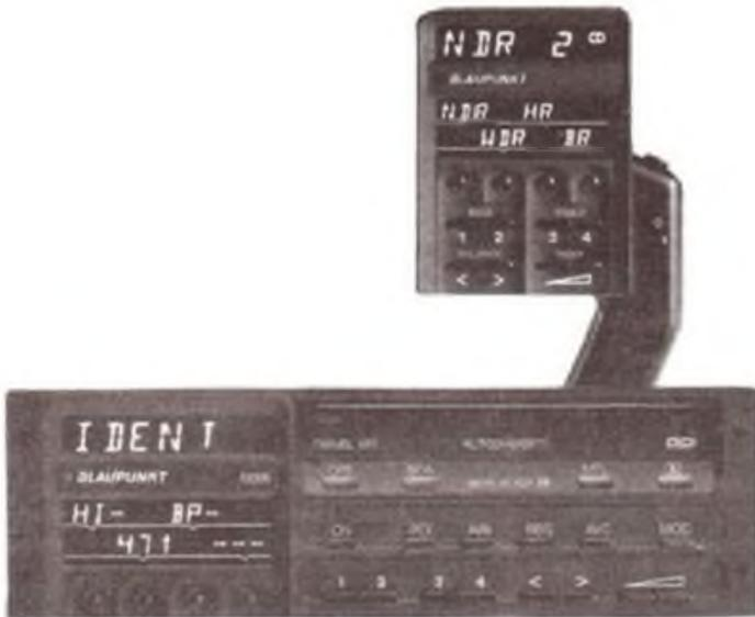
Das Blaupunkt-Spitzengerät Berlin QRB8 leistet dem Fahrer maximale Unterstützung mittels Senderidentifikation, Autodiversity und Programm-Direktwahl. Das heißt, man sieht, was man hört; man empfängt ein eingestelltes Programm immer auf der am besten empfangbaren Frequenz und kann schließlich die auf dem Display, das sich gut im Blickfeld installieren läßt, angebotenen Sender direkt anwählen.
