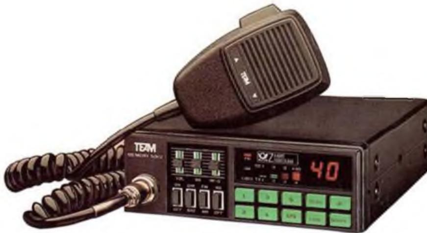
Das TEAM 5002 ist ein Mobilfunkgerät für verwöhnte CB-Funker. Neben einem 6-Kanal-Speicher besitzt das Gerät eine Suchauffunktion und eine Taste für den Notrufkanal 9. Es ist AM- und FM-Betrieb möglich. Ein Noise Blanker sorgt bei AM für eine Störaustattung im PKW. Weiterhin kann die Empfindlichkeit der HF-Vorstufe eingestellt werden.
