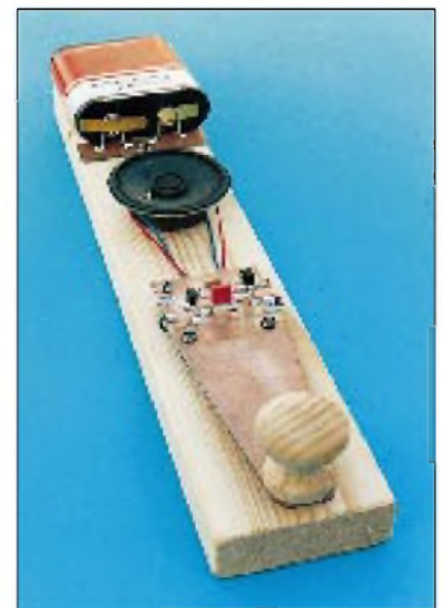
Bild 8: Ansicht der fertigen „integrierten“ Morsetaste
