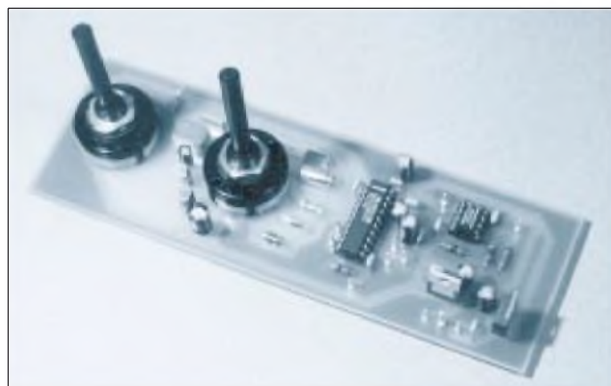
Bild 6: Die fertig aufgebaute Platine des Funktions- generators Foto: DL7UJW
