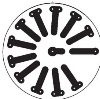
Bild 10: Optionale Anschlußplatine für die einstellbare Verzögerungsleitung PH2 (Leiterseite)
