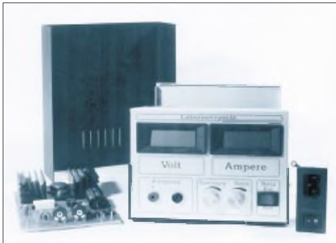
Bild 34: Fertig: Der kleine NF-Generator mit edler Alucorex-Frontplatte.
