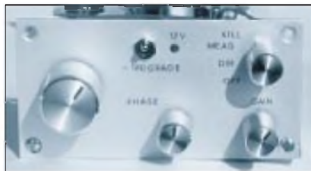
Bild 15: Frontseite mit Phasenreglern, 180°-Phasenumschalter, Verstärkungsregler und Betriebsmodusumschalter
