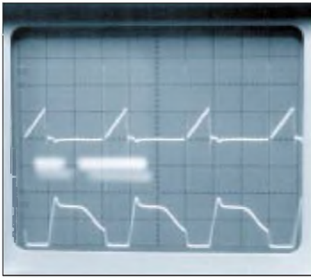
Bild 6: Die obere Kurve zeigt den Drainstrom, die untere Kurve zeigt die Drain/Source-Spannung von T2. Der Arbeitspunkt betrug bei dieser Aufnahme: U_{\text{Eff}} = 115 \text{ V} ; U_A = 15 \text{ V} ; I_A = 1,25 \text{ A} . Fotos: Autor
