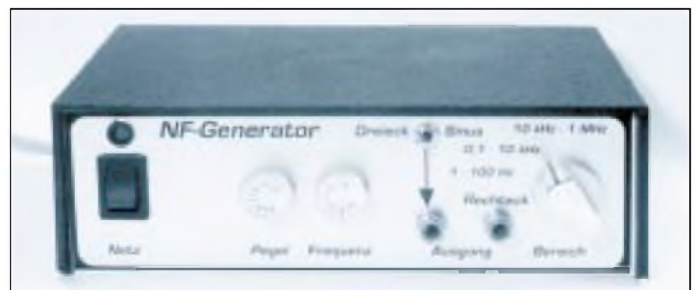
Bild 34: Fertig: Der kleine NF-Generator mit edler Alucorex-Frontplatte.
