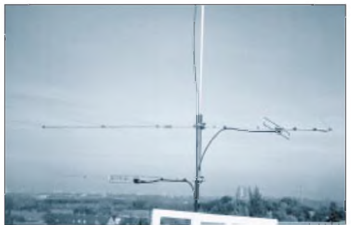
Bild 17: Anordnung von Hauptantenne und Hilfsantenne
