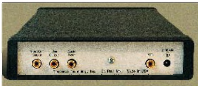
▲ Bild 2: Auf der Rückseite des DSP-59+ befinden sich Buchsen für den Lautsprecherausgang, den Leitungsausgang, den NF-Eingang, die PTT sowie die Stromversorgung (v.l.n.r.).
