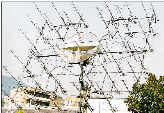
Die 70-cm-Antennenanlage von Koutarou, JA2ODV, aus Shizuoka. In der Mitte des Systems noch ein 1,8-m-Spiegel, auch für 70 cm
