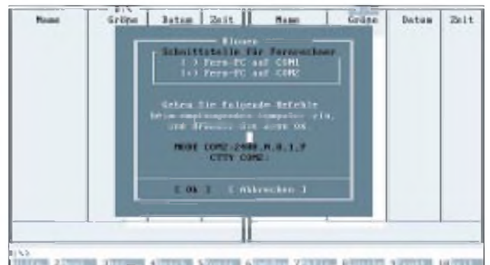
Falls der NC noch nicht auf dem zweiten PC installiert ist, kopiert sich NC selbst herüber.
