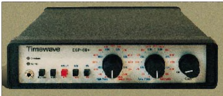
Bild 1: Frontansicht des DSP-59+. V.l.n.r.: die beiden LEDs „Normal“ und „Overload“, darunter der NF-Ausgang mit Klinkenbuchse, daneben die rastenden Drucktasten Bypass, AGC, HP+LP/BP, NRT/Tone, NRr für HP+LP/BP. Der linke Drehschalter bedient den HP, bei BP die Mittenfrequenz, bei „Option“ kann eine programmierte Mittenfrequenz für „Wideband Data“ eingeschaltet werden. Der rechte Drehschalter ist für den LP zuständig, bei BP für die Bandbreite. Rechts der Gain-Steller mit Einschalter.
