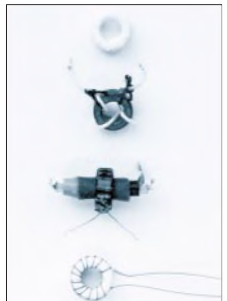
Bild 7: Zurichten der Übertrager-Sekundärwicklung; von oben nach unten: mit Folie bewickelter Kern - Kern für 10 W mit 3 Wdg. Kupferdraht mit Teflon-Isolation - einbaufertiger Übertrager für 100 W, Lackdraht auf lackiertem Kern; - fertiger Kern für 100 W Durchgangsleistung.
