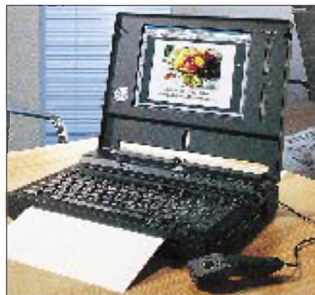
Canons COMPRI BN120C/100 vereint einen BubbleJet-Drucker und ein Notebook mit 100-MHz-IntelDX4-Prozessor in einem Gerät. Fotos: Deutsche Messe-AG, Sharp (2), Toshiba, Canon
