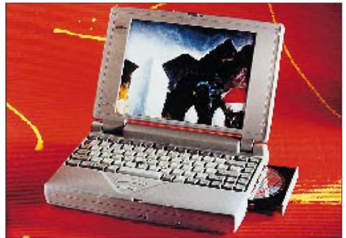
Das Satellite Pro Notebook T 2150 CDT von Toshiba besitzt ein eingebautes Doublespeed-CD-ROM-Laufwerk, eine Intel-DX4-CPU mit 75 MHz, 8 bis 32 MB RAM, eine 520-MB-Festplatte und einen TFT-Bildschirm mit 65 536 Farben.
