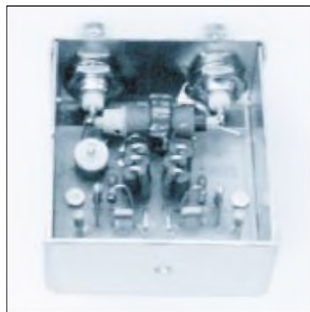
Bild 10: Blick auf einen bis auf den Anschluß der abgeschirmten Leitung fertig montierten Meßkopfes. Unter der Leiterplatte befindet sich noch eine Isolierfolie.
