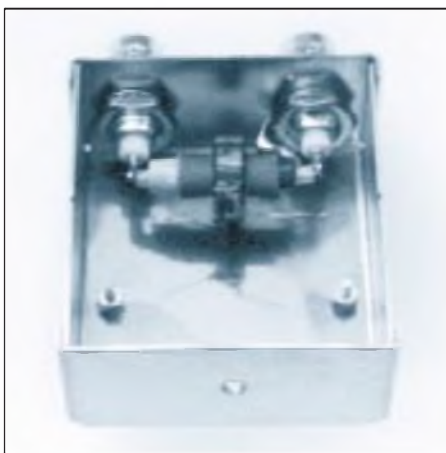
Bild 9: Mechanisch vorbereitetes Gehäuse mit montierten BNC-Buchsen. Der Übertrager wird vor der Montage der Leiterplatten zwischen den BNC-Buchsen gelötet.
