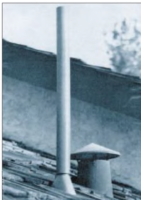
Bild 4: Die Ventenna setzt auf Tarnung und wirkt als Halbwellenantenne für 2 m oder 70 cm.
