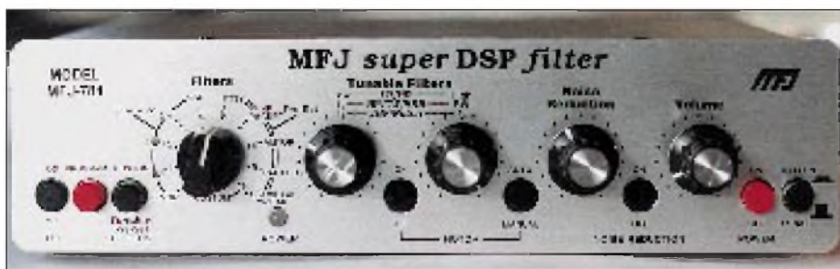
Bild 1: Die Frontplatte des MFJ-784. Klar beschriftet und übersichtlich gegliedert. Viele Funktionen erklären sich so von selbst.
