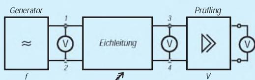
**Bild 10:** Meßschaltung zur Ermittlung der Verstärkung  $V$  in dB mit Hilfe der in dB-Werten einstellbaren Dämpfungskette „Eichleitung“.
