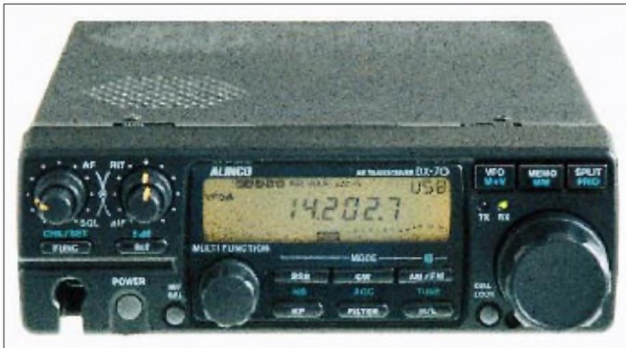
Bild 1: Das Display des DX-70 zeigt die Frequenz auf 100 Hz genau an.
