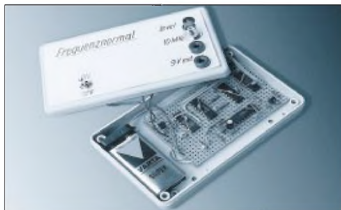
Bild 8: Ansicht des Musteraufbaus des vielseitigen Frequenznormals
