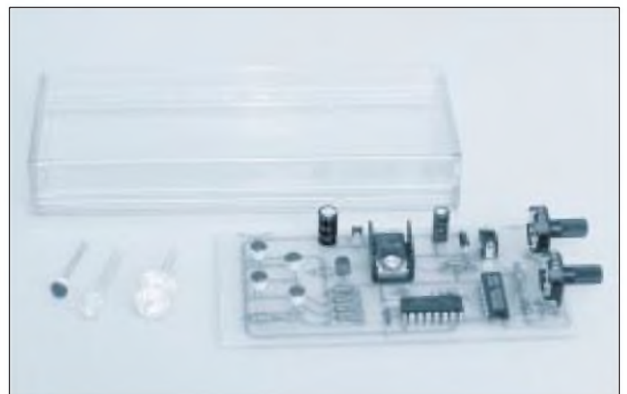
Bild 4: Im Mustergerät wurden Multichip-LEDs eingesetzt
