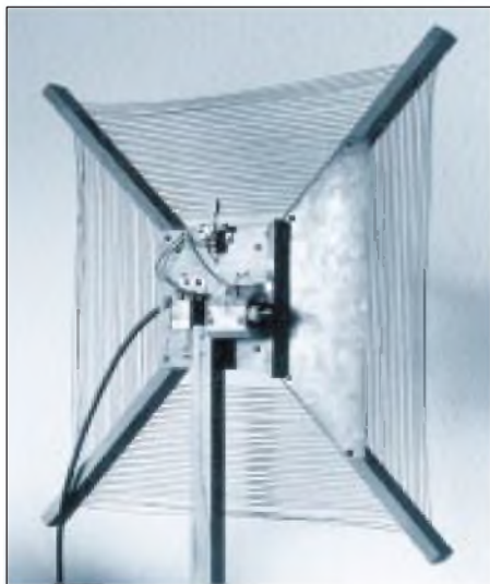
Rahmenantenne für besseren MW-Empfang Fotos: Hans Weber
