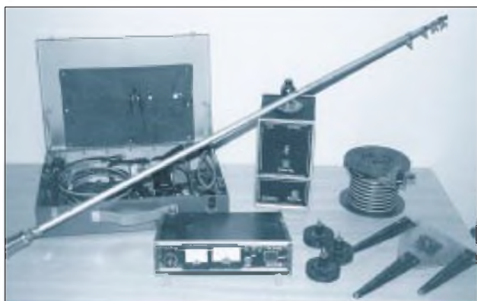
Bild 1: Die Antenne und das gesamte Zusatz-Equipment. Ein Meißgerät am SWR-Meter/Steuergerät zeigt übrigens den Strom im Antennenkabel an, was sich als sehr hilfreich beim Abstimmen erwies.
