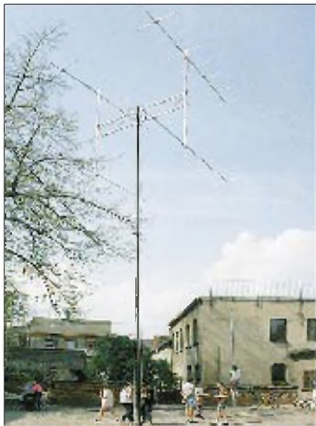
Die 2-m-Antennengruppe auf dem Schulhof anläßlich eines Schulfestes Foto: Michael Tauber, DG0MA
