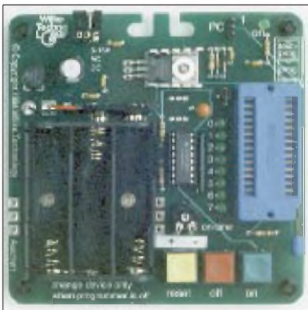
Bild 5: Der Programmierer für den „Knopf“. Links die Halterung für die drei Batterien, rechts außen die Halterung für den Knopf. Der Knopf wird unten oder oben eingesteckt, abhängig davon, ob geschrieben oder testweise gelesen wird.
