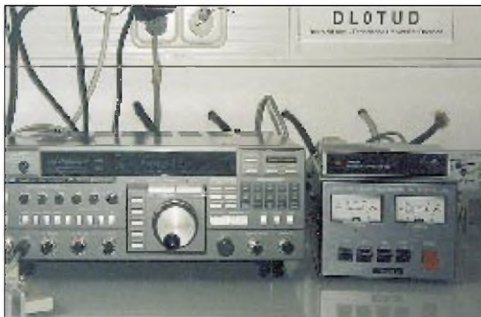
Bild 1: Die KW-Station von DL0TUD. TS-850 mit Computerinterface IF-232 (re. oben) und PTC-Controller (Mitte), links ein 386/SX20 mit Swisilog-Ausbreitungsvorhersage
