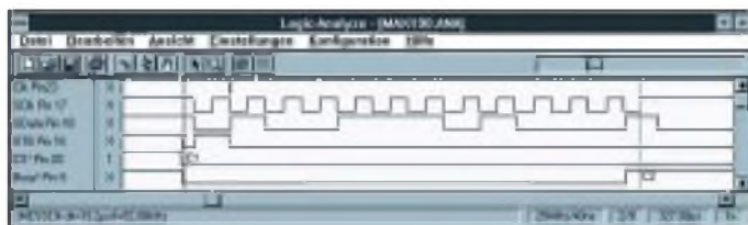
Bild 2: Timing der seriellen Schnittstelle des MAX190
