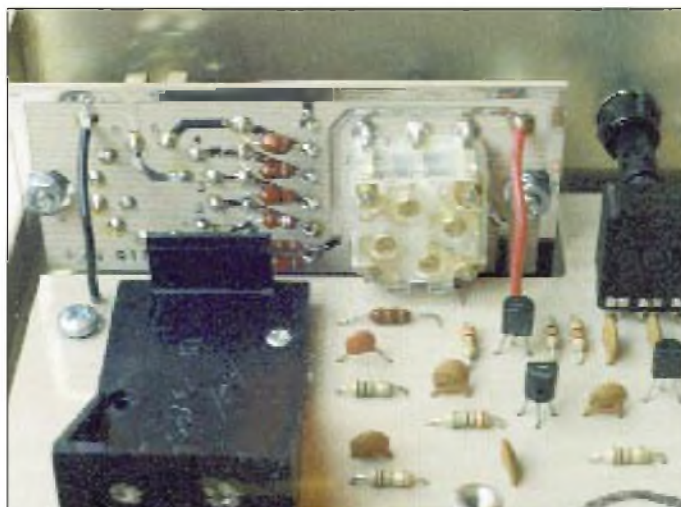
Bild 4: Blick auf die Selektionsmittel. Auf der separaten Platine (befestigt an der Frontplatte) befinden sich links der Bandschalter, es folgen die sechs Festinduktivitäten und rechts der Drehkondensator. Unten im Bild noch sichtbar der Stehbolzen für die Teleskopantenne. Fotos: Autor
