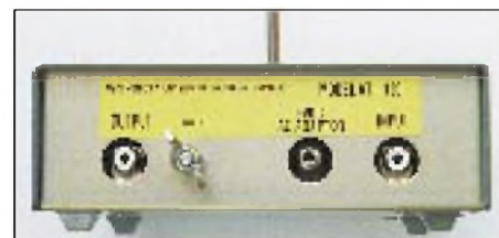
Bild 2: Rückansicht der AT100. Von links nach rechts: Ausgangsbuchse Ausgang (Cinch), Masseschraube, Buchse für externe Stromversorgung (9 V Gleichspannung), Eingangs-Antennenbuchse (Cinch).
