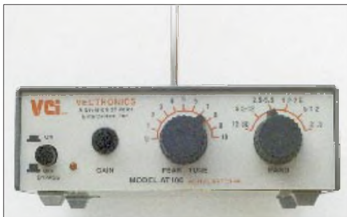
Bild 1: Frontansicht der AT100. Von links nach rechts: Schalter Bypass (gleichzeitig Ein/Aus-Schalter, LED für die Ein-Anzeige, Verstärkungs-Potentiometer, Drehkondensator zur Abstimmung, Bandschalter). In der Mitte der Oberseite die Teleskopantenne.
