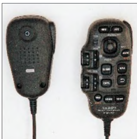
Bild 5: Die andere Seite zeigt die Unterschiede: Vier Rändelpotentiometer und der Joystick in der Mitte sind Merkmale des FS-10.
