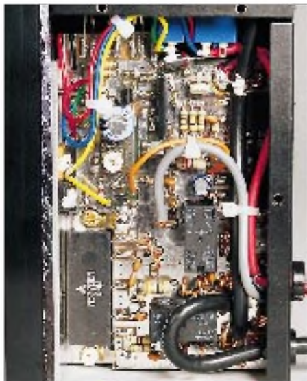
Bild 4: Blick ins Innere des Dualband Docking Boosters. Die Leistungsmodule sind gut zu erkennen. Oben in der Mitte ein weiteres Modul für die COX. Fotos: DL7UMO
