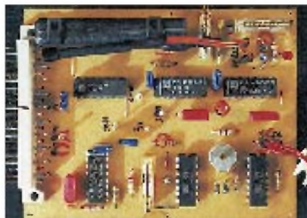
Musteraufbau der Meßsonde der BBS Jever: links die Mikrocontroller-Platine, rechts die Sensor-Platine, jeweils im halben Europaformat. Unter Leitung von Hans Tyedmers, DG6BY, wurden im Sommer '95 Missionen mit Heißluftballons durchgeführt. Fotos: DL3OBC
