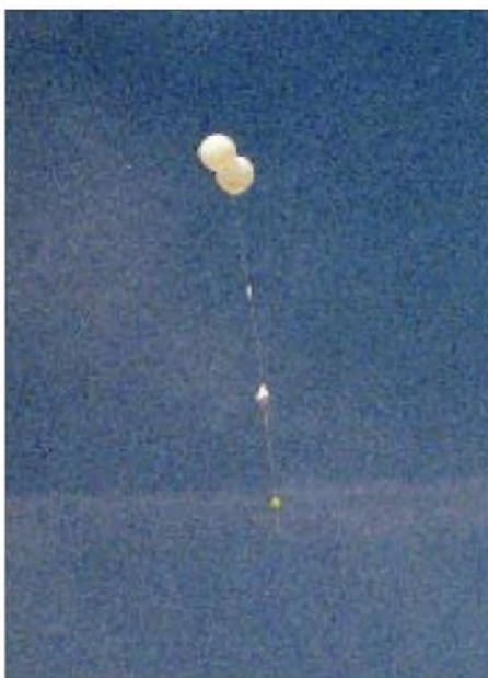
Beim Ballonstart am 22.10.95 in Hannover waren zwei Ballons notwendig, um die Nutzlast sicher an der hohen Europahalle vorbeizuziehen. Die beiden Ballons konnten ohne optische Instrumente noch mehr als eine halbe Stunde verfolgt werden. Foto: AATiS
