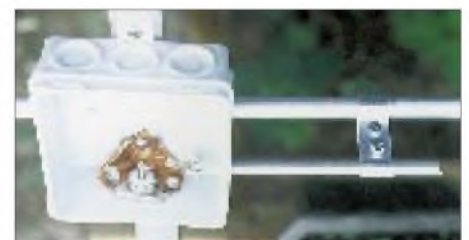
Bild 12: Praktische Ausführung der Gamma-Anpassung. Auf guten Massekontakt zwischen Buchse und Trägerrohr ist zu achten! Fotos: Autor
