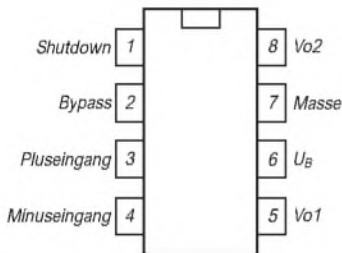
Bild 4: Pinbelegung des achtpoligen Small-outline-Gehäuses des Typs LM 4861 Boomer
