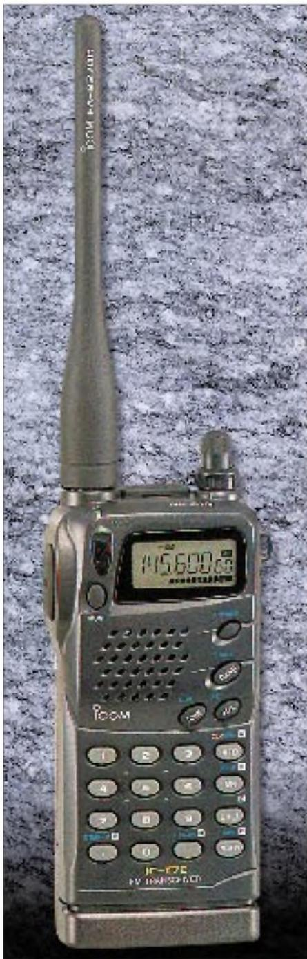
tiviert die Zweitbelegung. Unbeabsichtigte Fehlbedienungen soll die per Daumen-Druck einschaltbare Verriegelung aller Tasten vermeiden. Bei einer Größe von nur 57 mm x 122 mm x 29 mm einschließlich Akkupack liefert das IC-T7E bei 13,5 V 4 W HF im 2-m-Band und 3 W auf 70 cm, die sich in einer Low-Betriebsart auf 0,5 W reduzieren lassen. Der empfohlene Verkaufspreis liegt knapp unter 700 DM. *Bezug: Icom-Händler ab April '96, siehe Bezugsquellenverzeichnis*
