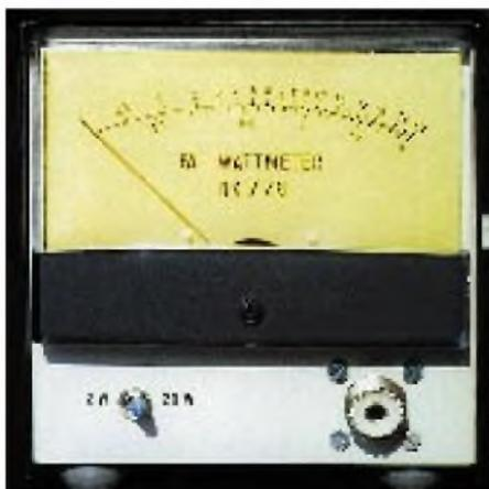
Bild 6: Das fertige QRP-Wattmeter
