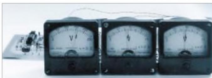
Bild 4: Drei Meßinstrumente dienen zur unkonventionellen Anzeige der Uhrzeit. Nachbauer müssen nicht befürchten, daß es sich um einen nicht-funktionierenden Aprilscherz handelt...
