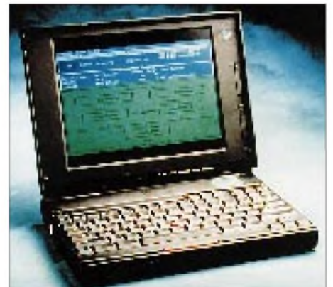
Bild 16: Der Notebook Sniffer Analyzer dekodiert über 200 LAN- und Internet-Protokolle in Echtzeit.
