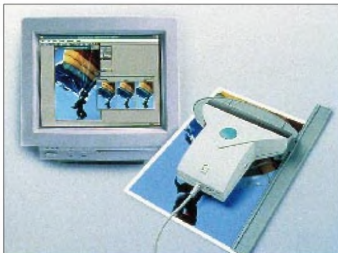
Bild 2: Handscanner sind meist nur für Vorlagenbreiten bis zu 10 cm ausgelegt.
