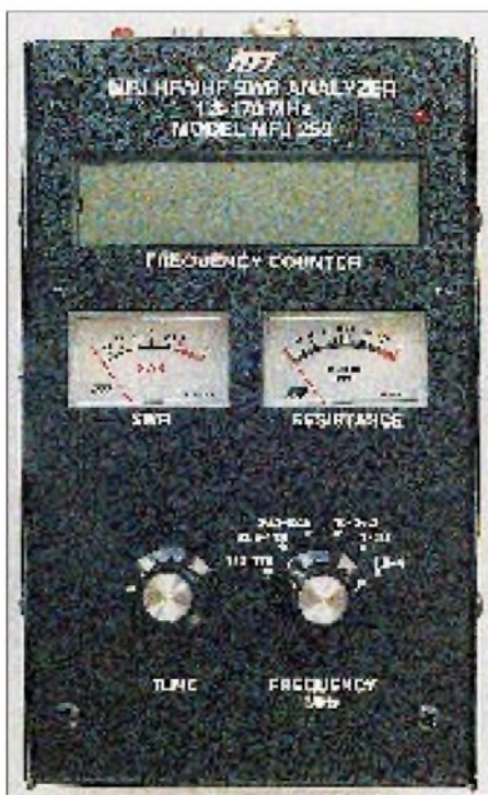
Bild 1: Frontansicht. Oben das LC-Display, darunter die Meßinstrumente für SWR und Widerstand. Links unten die Frequenzeinstellung, rechts der Bereichsschalter. Oben rechts oberhalb des Displays die LED für die Anzeige der Toröffnung. Die SWR-Anzeige hat s = 2 in der Mitte der Skale, oberhalb von s = 3 gibt es keine Skalierung mehr. Die Widerstandsskala zeigt zunehmende Stauchung oberhalb 100 Ω. Die Instrumente sind nicht beleuchtet, erzeugen jedoch einen hintergrundbeleuchteten Effekt.
