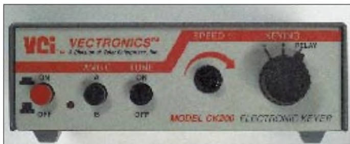
Bild 1: Frontansicht des CK 200 von Vecronics. An der Frontplatte befinden sich v.l.n.r.: Einschalter, Umschalter Iambic A/B, Abstimmknopf (Dauerträger), Steller Gebegeschwindigkeit sowie Umschalter für die Tastenausgänge (positiv, negativ, Relais)
