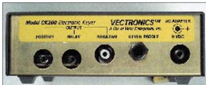
Bild 2: Rückansicht des CK 200. V.l.n.r. die Buchsen für die getrennten Tastausgänge (negativ: Cinch; Relais: 3,5-mm-Klinke, Stereo; positiv: 3,5-mm-Klinke, Stereo), die Gebegeschwindigkeit (Klinke 6,3 mm, Stereo) sowie die 9-V-Spannungsversorgung (Klinke 3,5 mm, Mono)
