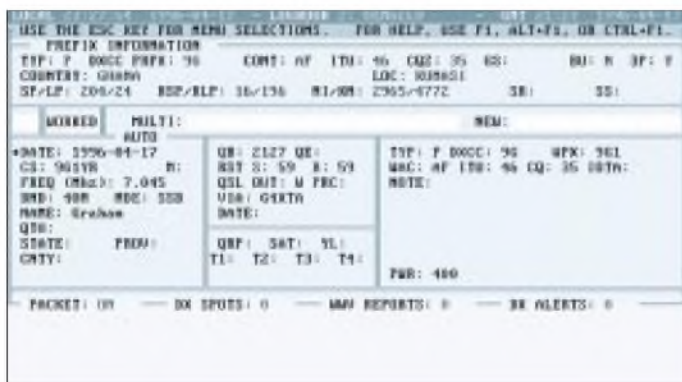
Bild 36: Der Eingabebildschirm des Professionell Logger V2.5 besteht aus vier Fenstern, dem dreizeiligen Präfix-Informationsfenster, dem einzeiligen Diplom-Statusfenster, dem QSO-Log-Fenster und dem Packet-Radio-Fenster.
