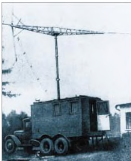
Mobile Impulsfunkmeßstation „Redoute“ (Sendeanlage) der Sowjetunion Fotos: Archiv Schlenker (3)
