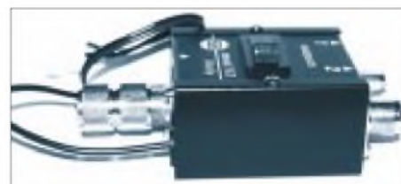
Bild 3: Für die mechanische Konstruktion der Umschalteneinrichtung findet ein allseits geschlossenes Metallgehäuse Verwendung.
