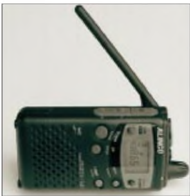
Christian Rockrohr, DC5CC, OE4CRC, Spezialist für Amateurfunk-Handys, gibt seine Meinung zu dem recht pfiffig dreinschauenden und preisgünstigen 70-cm-Zwerg Alinco DJ-S41 ab. Das Gerät besitzt keine Antennenbuchse, dafür eine ausklappbare und mit ihm fest verbundene Stabantenne.
