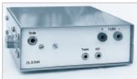
Bild 13: Rückansicht des Transceivers. Die Antennenbuchse befindet sich an der Seite.
