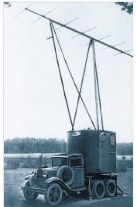
RUS-2: Erste sowjetische Funkmeßstation (Empfangsanlage) 1940
