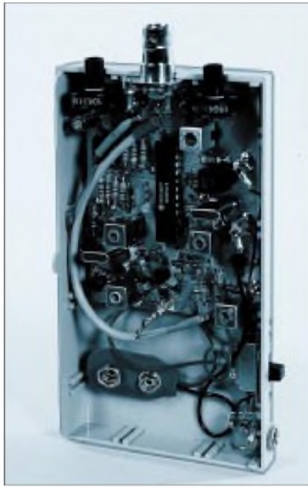
Bild 5: Ansicht des geöffneten Musters des Einkanal-FM-Empfängers
