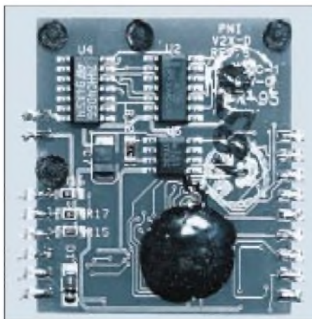
Bild 2: Die Intelligenz verbirgt sich unter dem „Harztropfen“. Fotos: Autor
