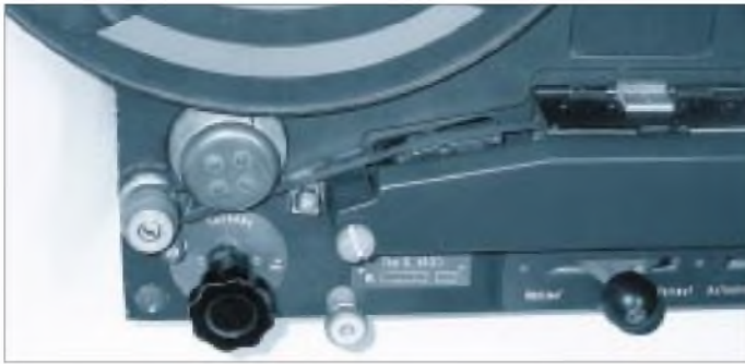
„Ton S. b 1“, Einzelheit mit „Dehnerkopf“
