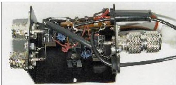
Bild 6: Der Einbau erfolgt in einen Antennenumschalter Mod.V2 von Zetagi.
