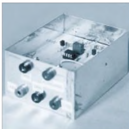
Bild 4: Ansicht des betriebsfertigen, in ein Standard-Weißblechgehäuse eingebauten HF-Milliwattvorsatzes.
