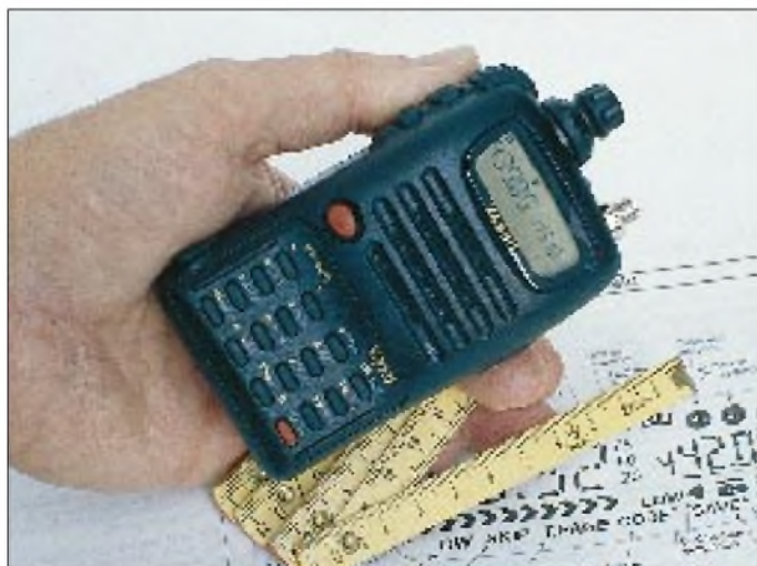
Technische Innovation, komprimiert auf kleinstem Raum: FT-50R von Yaesu. Doch alles bleibt bedienbar. Das LC-Display ist trotz der geringen Geräteabmessungen relativ groß ausgefallen, wovon besonders die Frequenzanzeige und die pfeilförmigen Segmente der Anzeige für relative Feldstärke und Sendeleistung profitieren. Für das Ablesen der Statusanzeigen – vor allem bei schlechter Beleuchtung – könnte eine Lesebrille nötig werden.
