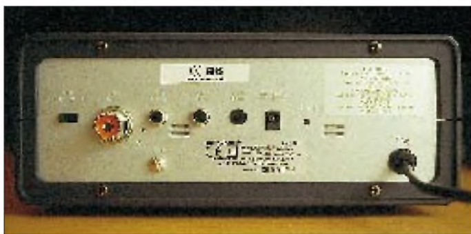
Auf der Rückseite des Empfängers finden sich alle notwendigen Anschlußmöglichkeiten, einschließlich zweier Antenneneingänge.
