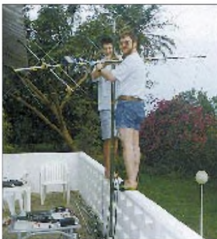
Ragnar, DL7URH, und Frank, DL7UFR, mit der Satellitenantenne: Die Elemente wurden mit Tape befestigt, ein Stück Holz hält die beiden Teile des Boomrohres.
