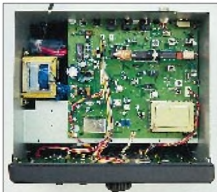
Ein Blick ins Innere des DX-394. Es bietet genügend Platz für eventuelle Modifikationen. Das Netzteil ist bereits eingebaut. Auch eine Ferritantenne für Lang- und Mittelwelle ist vorhanden, die jedoch bei Anschluß einer Außenantenne ihre Richtwirkung verliert.
