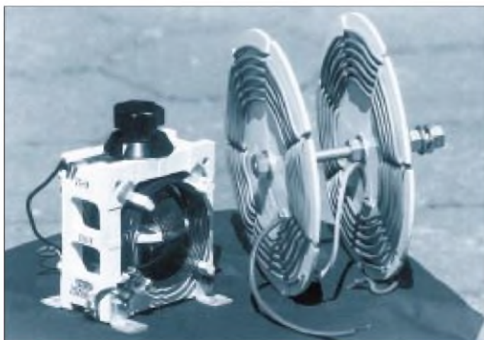
Bild 9: Ansicht eines typischen Kugelvariometers (links) und eines Eigenbau-Scheibenvariometers
