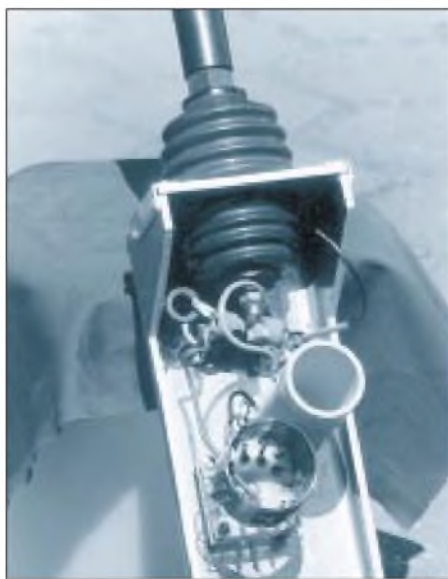
Bild 2: 80-m-Anpaßbox für eine 4,5 m lange Stabantenne. Links oben innerhalb der Halterung die keramischen Rohr Kondensatoren (3 Stck., insgesamt 1600 pF, darunter die angezapfte 5-µH-Luftspule, rechts davon die 40-µH-Spule mit aufgebrannter Wicklung.
