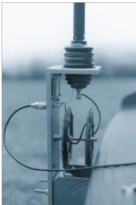
Bild 3: 80-m-Anpaßgerät für eine 4,5 m lange Stabantenne, ähnlich Bild 3, aber mit Scheibenvariometer und selbst zusammengesetztem Glimmerkondensator, betriebsfertig an die Hängerkupplung montiert
