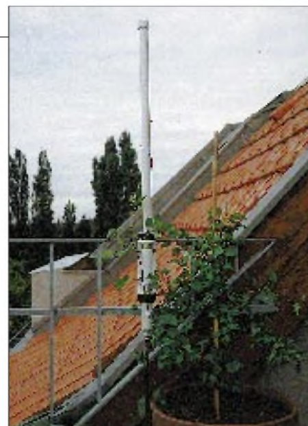
Bild 1: Aktivantennen lassen bequem sich am Balkongitter anbringen und erforderlichenfalls mit Grünpflanzen tarnen.
