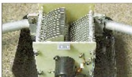
Oben in der Plastikabdeckung der spannungsfeste Split-Drehkondensator mit großflächigen Verschraubungen für die Strahlerschleife sowie dem Antriebsmotor ▼
