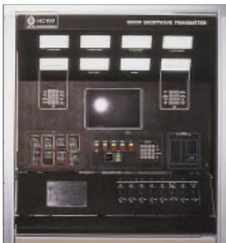
Die Ingenieure von Radio HCJB haben die eingesetzten Kurzwellensender zum Teil selbst entwickelt. Hier einer der 100-kW-Sender mit der Typenbezeichnung HC 100.
