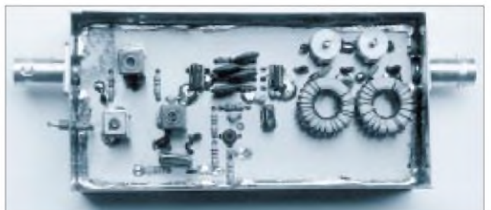
Bild 5: Blick von oben in einen betriebsfertig aufgebauten Konverter
