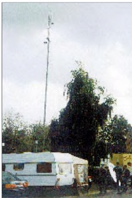
Ein 14-m-Mast stellte sicher, daß die 13-cm-Verbindung zum ASTV-Relais DB0LE in Leer klappte.
