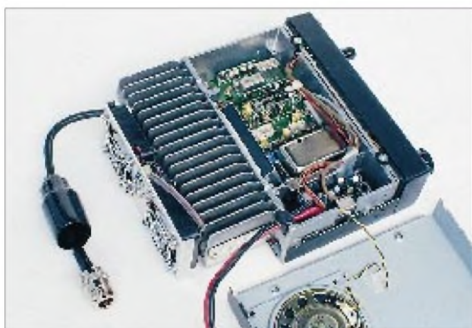
Denpas neues MZ-45 zeigt in der Innenansicht solide Betriebsfunkqualität mit relativ großen Vor- und Zwischenkreisen für vernünftige Empfangsleistungen. Fotos: --ro-
