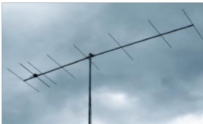
Bild 20: Die 8-Element-Yagi mit gestrecktem Dipol
