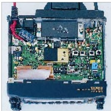
Innenansicht die erste: Nach Abnehmen des Deckels und Ausklinken des Lautsprechers zeigt sich dieses aufgeräumte Bild.
