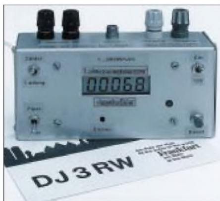
Ein sehr nützliches Ladungsmengenmeßgerät läßt sich mit Hilfe des Conrad-Bausatzes selbst herstellen. Die Beschriftung des Aluminiumgehäuses erfolgte mit dem P-touch-System.
