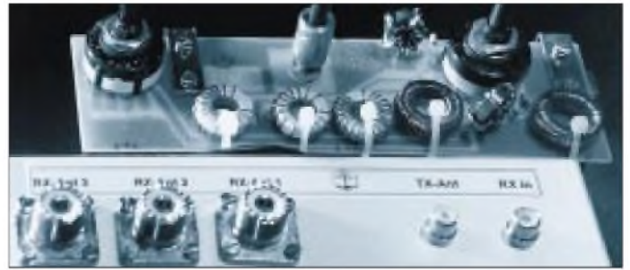
Bild 4: Der BCC-Preselektor mit herausgeklappter Leiterplatte
