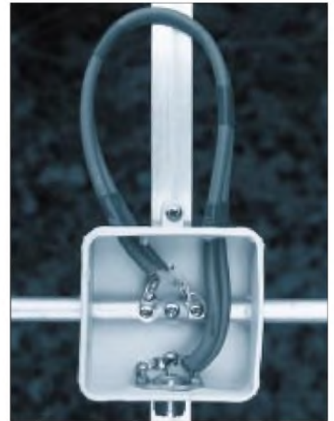
Bild 17: Die Anschlußdose mit gestrecktem Dipol als Strahlerelement
