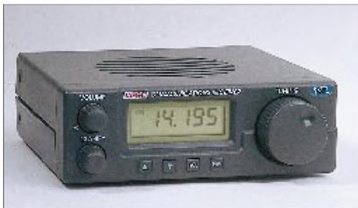
Bild 1: Ansicht des etwa autoradiogroßen Empfängers Target HF 3 Foto: Nils Schiffhauer
