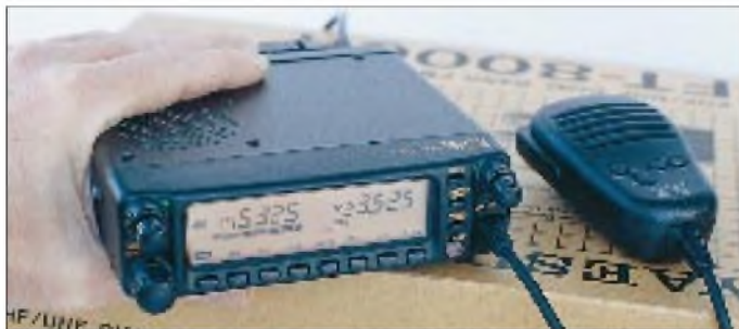
Das FT-8000R enthält als Bonbon noch einen sehr weiten Empfangsbereich bis ins 23-cm-Band (1300 MHz). Sehr praktisch ist die je nach Betriebszustand im Display erscheinende Beschriftung der acht darunter befindlichen Tasten.
