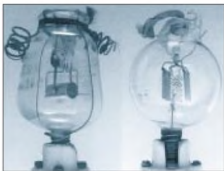
Röhre NT9X von Marconi-Osram (links) und ein „spherical audion“ der der British Thomson-Houston Company (1916)
