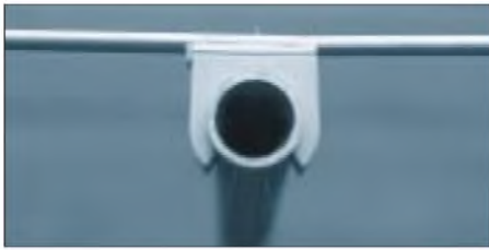
Bild 15: Befestigung der Elemente zu Meßzwecken mit Kunststoffklammern auf 25-mm-Aluminiumrohr
