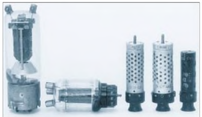
Die Telefonröhre BO (links) heizte mit 1,8 V/1,1 A und gilt als der Prototyp der deutschen kommerziellen Röhren; rechts der Nachfolgetyp Ba.
