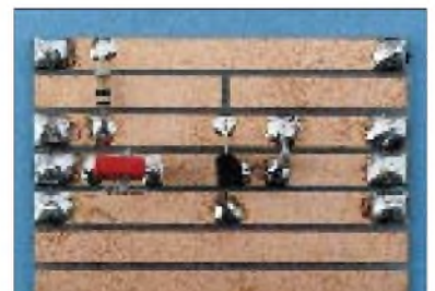
Der NF-Verstärker, aufgebaut auf einer Streifenleiterplatte
