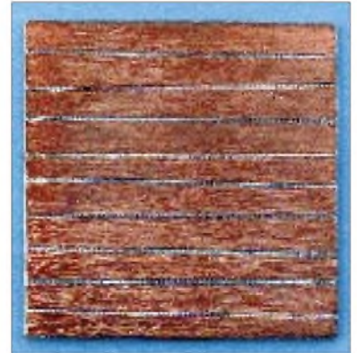
Es geht auch ohne Schraubstock: Streifenleiterplatte „freihändig“ mit Lineal und Reißnadel geritzt.
