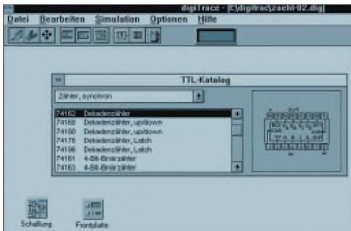
Bild 12: Im Programm digiTrace kann man auf einen TTL-Katalog zugreifen. Er enthält Rubriken für Gatter, Flip-Flops, Zähler, sonstige Bauteile, Bedienelemente, Hardware für an einer Schnittstelle anzuschließende Ein- und Ausgab.
