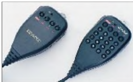
Links das Serienmikrofon MC-45, das schon eine einfache Fernbedienung erlaubt. Mit einem Fernbedienungsmikrofon wie dem MC-45DM (rechts) oder dem MC-53DM läßt sich der TM-V7E in allen wichtigen Funktionen fernbedienen. Fotos: DC5CC
