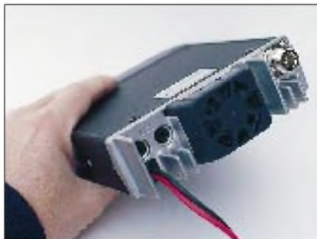
Der kleine Lüfter an der Geräterückseite sorgt für frischen Wind, sobald die PTT-Taste betätigt wurde.
