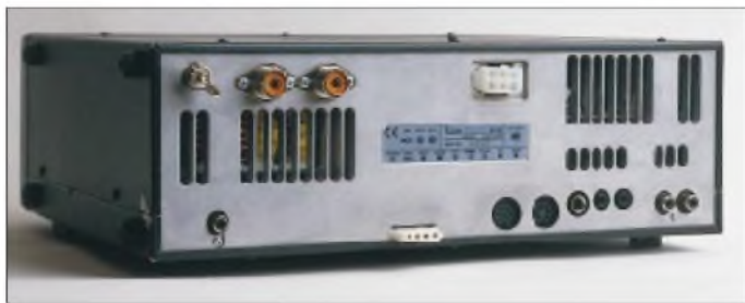
Bild 2: Schlicht und geordnet die Rückseite; die Computer-Buchse CI-V, die beiden DIN-, eine RX-Antennen-, zwei Sendeantennen- sowie die Zubehörbuchse bieten genug Kontakte zur Außenwelt.
