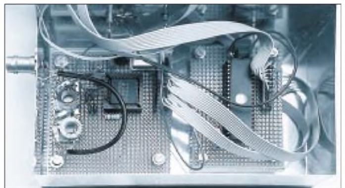
Bild 3: Der Aufbau des DDS-Frequenzgenerators erfolgte auf einer Lochrasterplatte.
