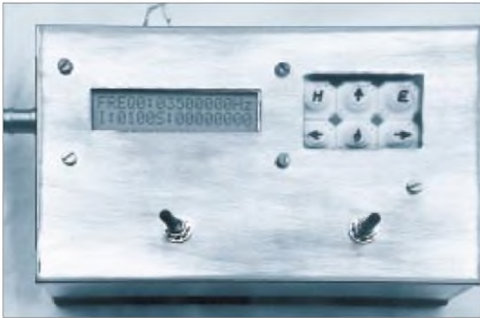
Bild 4: Außenansicht des Generators. Das zweizeilige Punktmatrix-Display zeigt oben die Frequenz und darunter die Abstimm-schrittweite und den Frequenzversatz an. Fotos: DL9FCR
