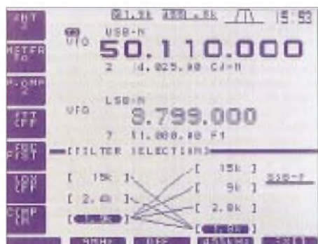
Bild 5: Das Filter-Kombinations-Menü gestattet die Auswahl der Filter in der 2. und 3. ZF. Die Linien geben zulässige Kombinationen an. Unten und links die Beschriftung der Softkeys
