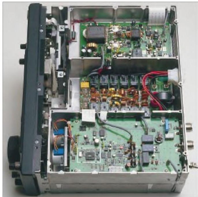
Bild 4: Auf der Oberseite muß auch erst ein großes Abschirmblech entfernt werden, damit dieser Blick unter anderem auf die per Relais geschalteten Tiefpaßfilter sowie den automatischen Antennentuner freigegeben wird.
