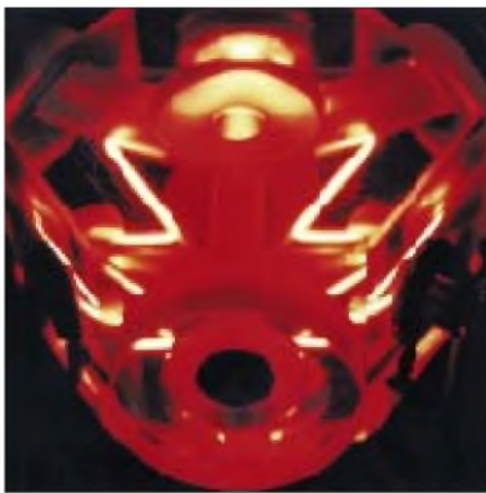
Micro-Lasergyro mit 12 cm Strahllänge Foto: SFENA
