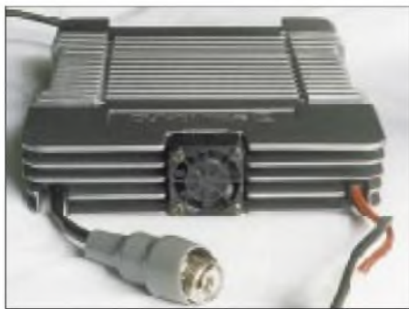
Für die Kühlung der Endstufe des Boosters sorgt außer dem massiven Gehäuse ein winziger Lüfter; die PL-Buchse ist abgesetzt.
