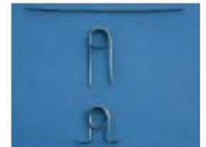
So biegen wir einen Draht, um Halterungen für die Batteriefahren zu erhalten.
