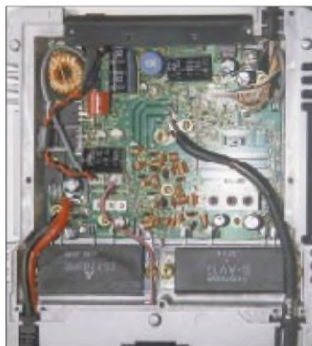
Blick in das Innere des Boosters CPB510E: Kräftige Module, Frequenzweichen, elektronische S/E-Umschaltung und Spannungsstabilisatoren bestimmen das Bild.
