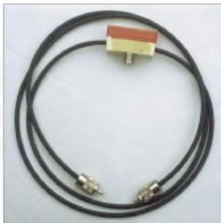
Bild 16: Fertiges Aufstockkabel für den Portabeinsatz
