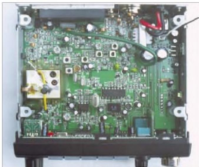
schwachpunkt des AE 550, denn die geringere Leistung ist für einwandfreien Mobilbetrieb meist zu niedrig; bei High erwärmt sich das Gerät andererseits beunruhigend schnell. Das angegebene Betriebsspannungsmaximum von 16 V erscheint deshalb als sehr hoch gegriffen. Bei dieser Spannung hat der Winzling über 100 W (!) Leistungsaufnahme, und man sollte davon unbedingt Abstand nehmen.
