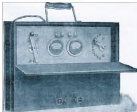
Schema eines Pendelgleichrichters und Pendelgleichrichter-Einrichtung zum Laden von Kleinakkumulatoren der Elektrizitäts AG Hydra Werk. Durch das abwechselnde Schließen der Kontakte k1 und k2 wird aus der Wechselspannung der Sekundärspulen eine synchron pulsierende Gleichspannung.
