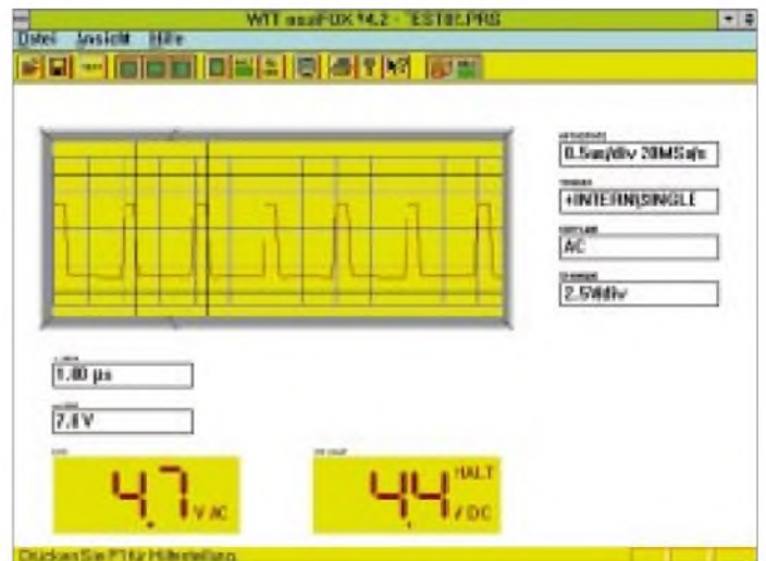
Bild 7: Spannungsverlauf am 1-MHz-Ausgang eines Teilers. Die vier Fenster oben rechts geben Auskunft über die Einstellung des osziFOX, die beiden unteren links zeigen die Zeitdifferenz (umschaltbar auf Frequenz) und darunter die Spannungsdifferenz der insgesamt vier hier nachträglich gesetzten Cursorsen.
