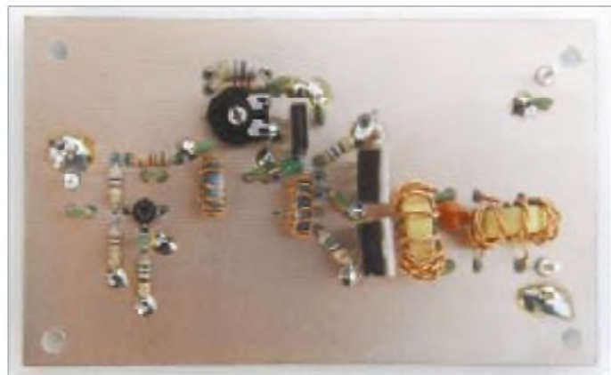
Bild 4: Ansicht der fertig bewickelten Kerne für die Endstufe
