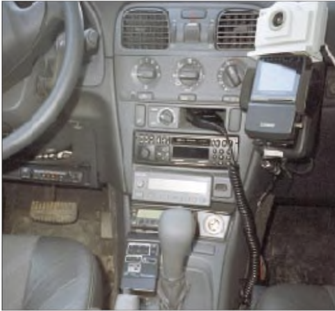
Bild 4: SSTV-Mobil auf 2 m und 70 cm ist, wie man sieht, kein Problem. In der Ablage der TSC-70P. Neben dem Schalthebel liegt die Fernbedienung. Neben der Konsole oben rechts die Handy-Halterung mit dem LCD-Fernsehempfänger als SSTV-Monitor und Kontrollmöglichkeit für das eigene Kamerabild, darüber im weißen Gehäuse die CCD-Farbkamera.
