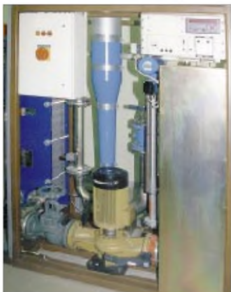
Die Kunstantenne erinnert an eine Pumpstation. Der eigentliche Abschlußwiderstand ist der sich rechts befindende Metallzylinder, links daneben das 50-Ω-Koaxial„kabel“.
