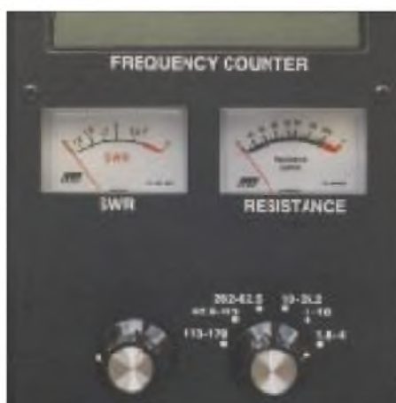
Bild 4: MFJ-259-Teilansicht mit Frequenzeinstellung, Bereichsschalter, Anzeigeinstrumenten und Display
