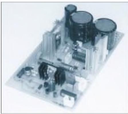
Bild 6: Das Netzteil wurde mit diskreten Bauelementen realisiert.
