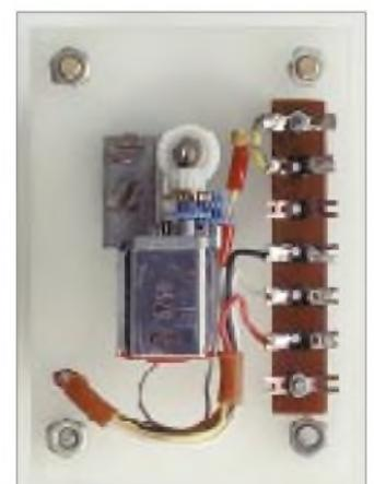
**Bild 3:** Die rechte Seitenplatte mit Motor und Getriebe
