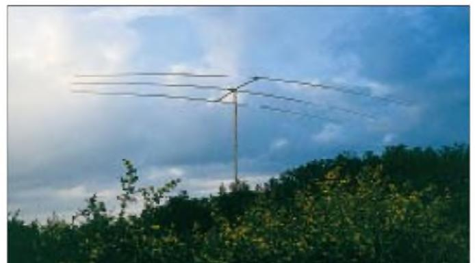
Bild 7: Die für 20 m eingestellte Yagi im Gestrüpp der Macchia auf Sardinien. Höhe über Grund 10 m
