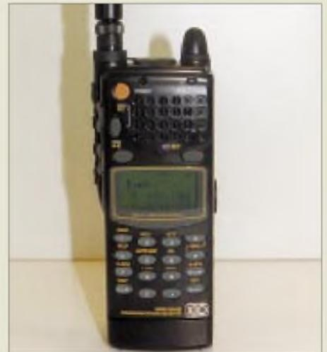
**Aincos DJ-X10 ist ein Breitband-Scanner für 100 kHz bis 2000 MHz mit 1200 Speicherplätzen, dessen Channel Scope bis zu 40 Kanäle gleichzeitig überwacht und im Display darstellt.**
