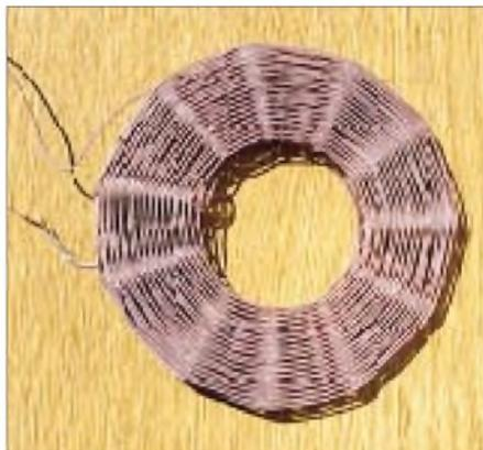
**Bild 6: Selbstgewickelte Wabenspule**
