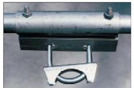
**Bild 3:** Elementbefestigung auf dem Boomrohr
