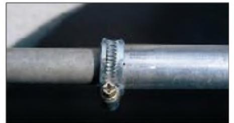
**Bild 2:** Rohrarretierung mit Hilfe von Schlauchschellen und Schlitten
