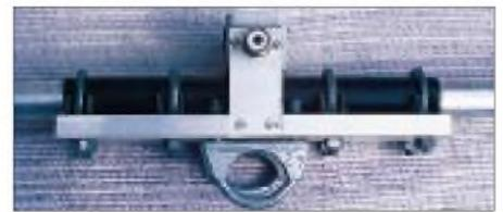
Bild 4: Das isoliert gehaltene Strahlermittelstück
