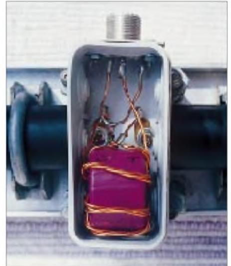
Bild 5: Anschlußdose mit Balun und Koaxialbuchse
