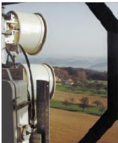
Hochleistungsantenne mit angebautem HF-Teil. Die Verbindung erfolgt durch flexibles Hohlleiterkabel. Fotos: DL1MEH
