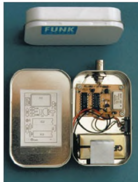
So sieht ein Eichpunktgeber aus, der in einer Apothekenschachtel bequem Platz findet.
