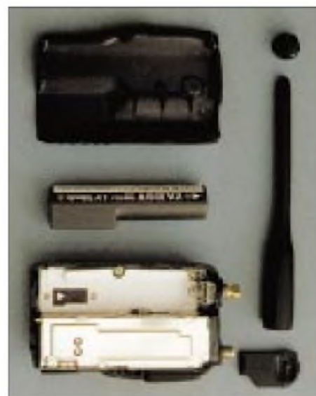
Das zerlegte VX-1R. In der Mitte ist der Lithium-Ionen-Akku, der etwas größer als eine Mignonzelle ist. Fotos: FA
