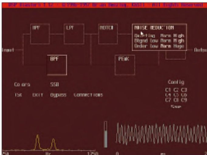
Bild 5: Telegrafiesignal mit aktiviertem Bandpaß- und Peak-Filter (800 Hz)
