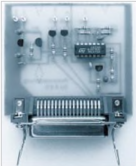
Bild 4: Ansicht der Platine für die Antennen- fernsteuerung
