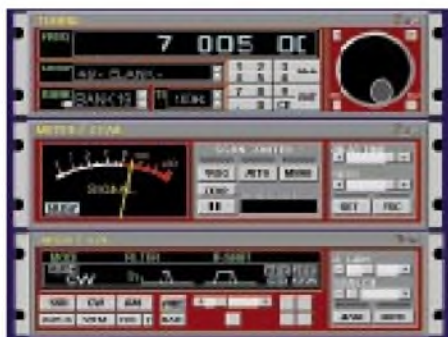
CW-Empfang auf 40 m. Man beachte die grafische Darstellung der ZF-Bandbreite und der ZF-Shift.
