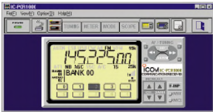
Der kleinste virtuelle Empfänger macht die Bedienung übersichtlich, verzichtet auf für den Empfang nicht unbedingt notwendige Details und braucht deshalb auf dem Bildschirm wenig Platz. Man wird ihn bevorzugen, wenn auf dem PC gleichzeitig noch andere Anwendungen laufen.
