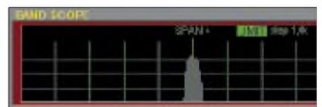
Ein einzelnes Signal bei hoher Auflösung von der Band-Scope-Darstellung dargestellt, ergibt ein Bild von der etwa 10 kHz breiten Durchlaßkurve des Scope-Kanals. Durch diese Bandbreite ergeben sich bei größeren Schrittweiten „Löcher“ zwischen den Kanälen.
