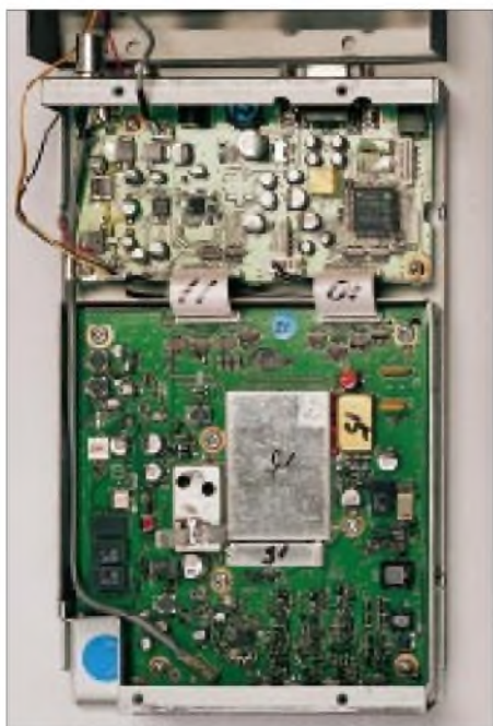
Der Blick ins Innere zeigt einen SMD-Aufbau mit Miniaturbauteilen, der die Leistungsfähigkeit kaum vermuten läßt.
