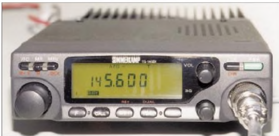
Die geringe Fläche der Frontplatte von 138 mm × 40 mm des TS-146 DX wird hier am ehesten im Größenvergleich mit dem Mikrofonstecker deutlich.
