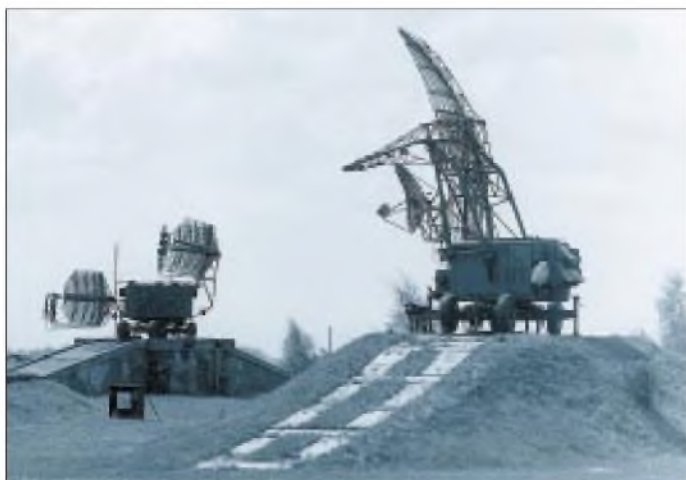
Funkentfernungsmesser P-37 (links) und Höhenfinder PRW-13 (Jägerleittechnik) auf Antennenständen zur Verbesserung der Ortung tieffliegender Ziele.
