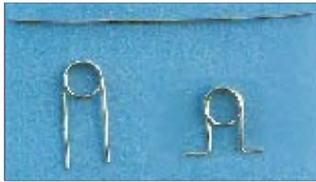
Fertigungsschritte bei der Herstellung der Batterieanschlüsse
