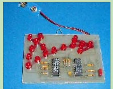
Fertig bestückte Platine des „Wegzeichens“
