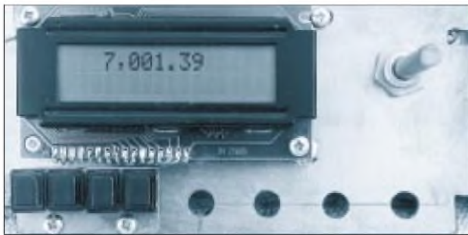
Bild 6: Die Frontseite der Baugruppe in Funktion. Neben dem LC-Display die Achse des Drehgebers, darunter die vier Menütasten, unten rechts die Bohrungen für die Potentiometer der Transceiverbaugruppe
