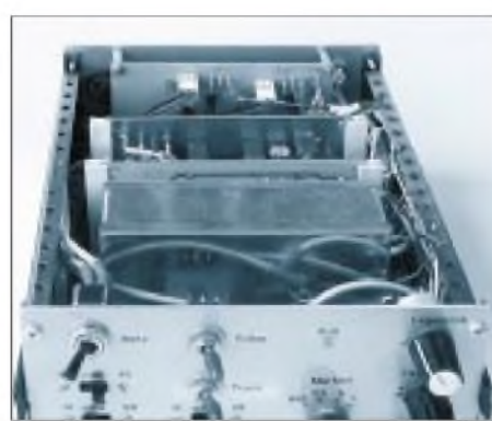
Bild 22: Blick in das Gerät. Vorn im Gehäuse die Platine 2 (HF-Teil), dann folgen Platine 1 (Ablenkteil) und Platine 3 (Marken u. Tracking-Generator) sowie die Stromversorgung.
