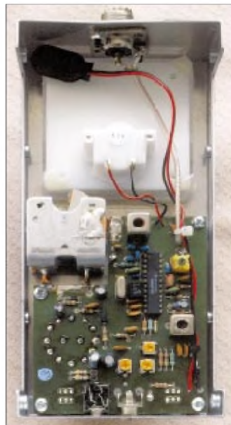
Innenansicht des MFJ-224. Links in der Mitte der Drehkondensator für die Frequenzeinstellung, daneben der IC MC 13135P als Herz der Schaltung Fotos: DL7UJM
