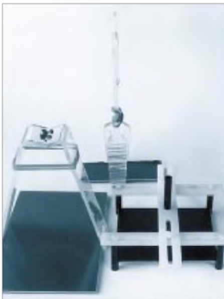
Hinten im Bild die ehemalige Gebäckzange mit dem Gummiring. Eingespannt ist eine Platine 30 mm x 100 mm. Links vorn die Eigenbauzange. Oben das Scharnier mit den Schrauben, unten am rechten Schenkel ist die Aussparung zu sehen. Die Platine hier ist 100 mm x 160 mm. Rechts die aufwendigere Halterung. Eine Distanzrolle dient als Griff. Die gehaltene Platine ist 110 mm x 110 mm.
