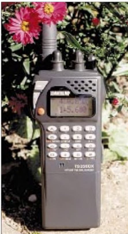
Auffällig sind das große, alphanumerische Display und der winzige Lautsprecher. Display und Tastatur lassen sich grün beleuchten.
