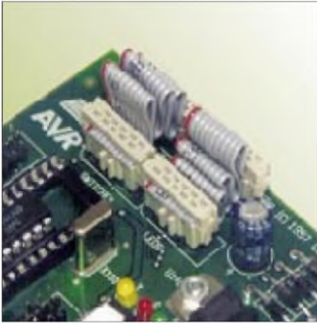
Bild 2: Flachbandleitungen verbinden die I/O-Leitungen.
