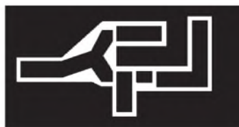
Bild 3: Trennlinien-Leitungsführung der Platine für die HF-Meßbrücke
