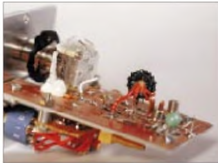
Bild 8: Detailansicht des KW-Bausteins mit HF-Transformator
