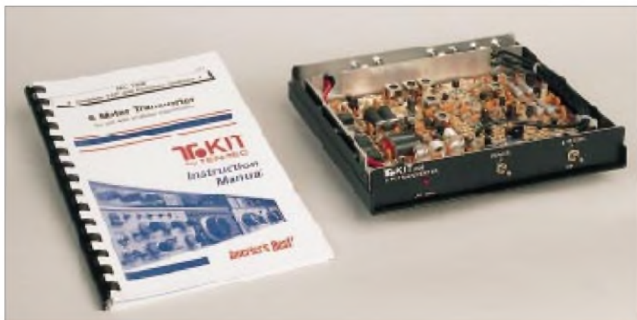
Der fertige Transverter ist kaum größer als das ausführliche Manual. Bei sorgfältiger Arbeit ist das Produkt von einer industriell gefertigten Version nicht zu unterscheiden (s. auch Titelbild). Foto: FA
