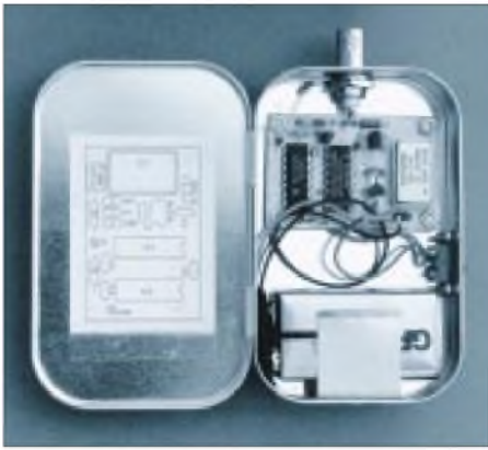
Bild 7: Eingebaut wurde der Markengenerator in eine Tabletten-Weißblechdose und darf damit als Beispiel eines der „Wochenendprojekte in Dosen“ gelten.
