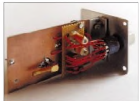
Bild 6: KW-Modul mit unten angebrachten Bereichsspulen, Kondensatoren und SMB-Buchse
