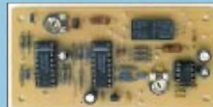
Ein wenig bekannter, aber sehr effektiver Filter-Schaltkreis ist der MF 8 von National Semiconductor. Damit lassen sich mit wenigen externen Bauelementen (wie man sieht) leistungsfähige Filter, hier für CW, aufbauen. Foto: DL7UMO
