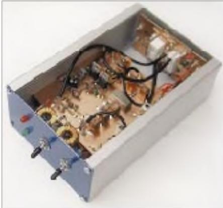
**Bild 13: Ansicht eines betriebsbereiten Transverters**
