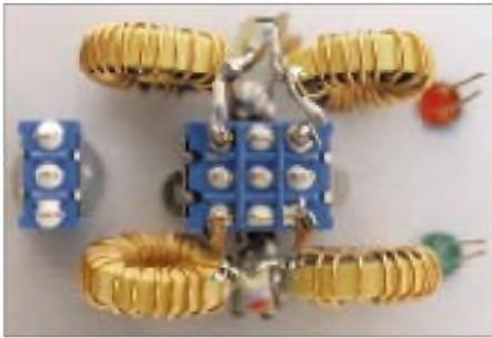
**Bild 12: Die freitragende Befestigung der Bandpaß-Bauelemente an dem Band-Umschalter**
