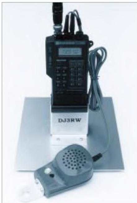
**Bild 3:** Handy als Feststation mit Telefonhörkapsel als Lautsprecher-Mikrofon
