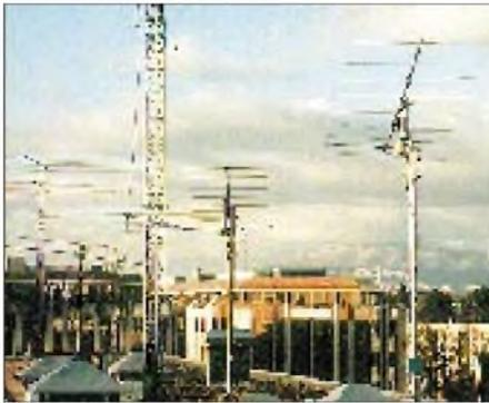
**4U1TU-DXpedition: Vom 11. bis 15.12. aktivierten Wolfgang, DF8AA, und Steffen, DD0VF, die UN-Station in Genf auf 2 und 6 m. Im Meteorscatterbetrieb gelangen 25 QSOs. Im Bild die neuerrichteten Antennen für den 2-m-Betrieb (8- und 9-Ele.-Yagi).**
