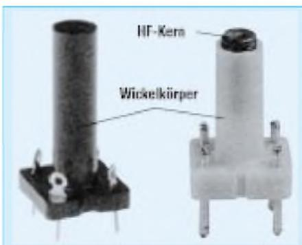
**Bild 1:** Für „offene“ Spulen mit oder ohne HF-Eisenkern liefert die Industrie eine große Auswahl an Stiefel- und Rohrkörpern aus Isoliermaterial (Kunststoff, Keramik u. dgl.), die man auf eine Träger- bzw. Leiterplatte montieren kann.
