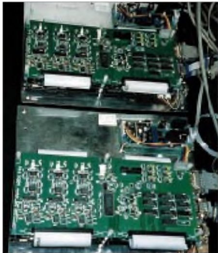
Blick ins Labor von Dale, N3EUA, wo Software- und Hardwareentwicklungen für das Phase 3-D-Experiment realisiert werden. Zu sehen sind Baugruppen der Digitalsektion des SCOPE-Kamera-Experiments. Foto: KB5MU
