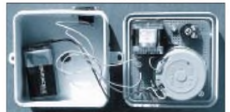
Bild 4: Aufbau des Summers in einem Weich-PVC-Gehäuse
