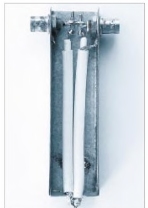
Bild 14: Saugkreisfilter aus Koaxialkabel realisiert Fotos: DL2JSH
