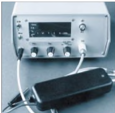
Bild 1: Frontale Sicht auf das Gerät. Unten links die DC-Buchse für den externen Vorteiler (angesteckt). Es folgen die Drehschalter Funktion, Torzeit und Kanalwahl. Rechts ragen die 2 BNC-Buchsen des Eingangsverstärkers/Impulsformers aus der Frontplatte.
