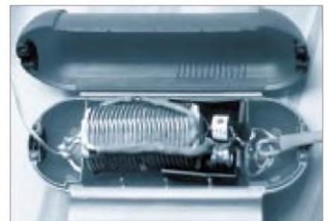
**Bild 3:** So läßt sich ein W3DZZ-Sperrkreis in die Safe-El-Box einbauen.
