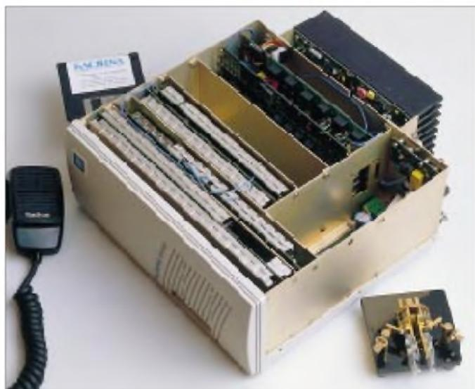
bei breitbandiger 50-Ω-Technik und großsignalfester Bauweise gilt in der Empfängerentwicklung der Profis seit über 25 Jahren als der Goldweg. Der KC 505 DSP verfügt über einen Doppelbalance-Schottky-Hochstrom-Ringmischer im Eingang, der beste Anpassung auch im Sperrbereich des nachfolgenden breiten Filters garantiert.
