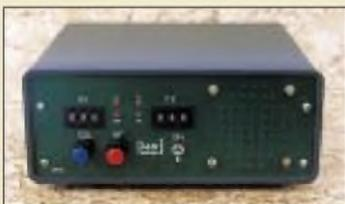
Das Pa(c)ket Radio ist ein über das gesamte 70-cm-Band abstimmbarer Transceiver für 1200 und 9600 Bps, der etwa 5 W HF liefert.
