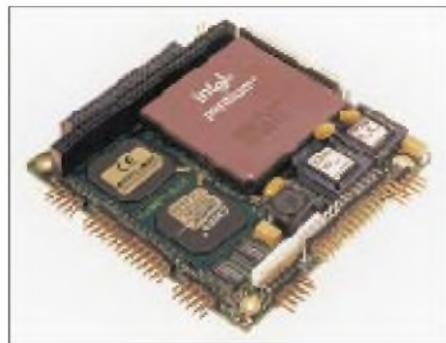
**Bild 8:** Der wohl kleinste Pentium-Rechner im PC/104-Format wurde um weitere Features ergänzt: Auf einer Fläche von 90 mm x 96 mm ist der gesamte Pentium-PC mit allen Schnittstellen, dem Videochip und neu mit bis zu 64 MB DRAM und einem 3,3-V-Schaltregler untergebracht. Foto: Digital-Logic AG
