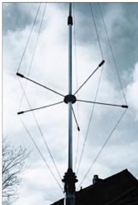
**Bild 7:** Die Seitendrähte sind beweglich geführt.
