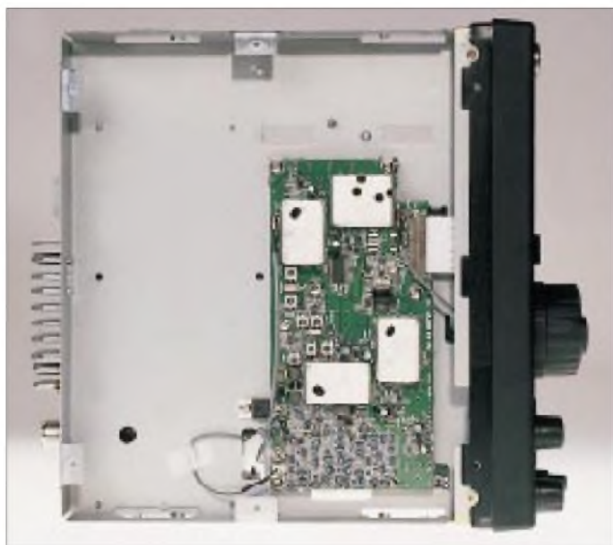
Unter dem Chassisblech sieht es dank der durchgängig eingesetzten SMD-Technik besonders geräumig aus. Hier ist die lediglich untergebracht, auf der ganz logisch auch die Empfänger-eingangs- und Senderzwischenstufen beheimatet sind.
