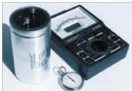
Kapazitätswerte, bestimmt mit Uhr und Multimeter Foto: DJ3RW
