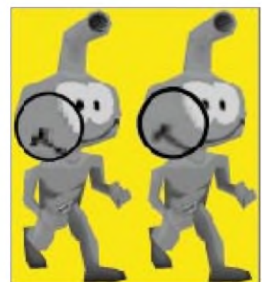
Bild 11: Lineares Texturemapping (links) und bilineares Texturemapping (rechts).
