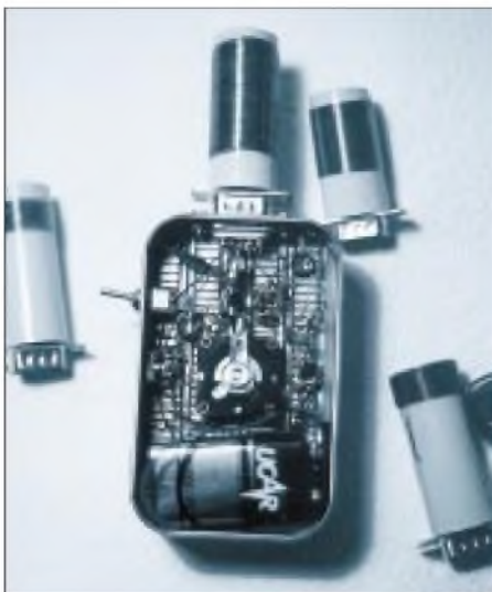
Bild 3: Blick in die Verdrahtung des FET-Dippers. In der Mitte ist der Drehkondensator zu erkennen, darüber der FET, rechts oben die LED und rechts neben dem Drehkondensator die beiden BC 547 C.
