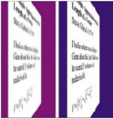
Bild 12: Trilineares Texturemapping (links) und anisotropisches Texturemapping (rechts)
