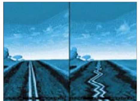
Bild 14: Perspektivische Korrektur bei 3D-Spielen: links korrekt, rechts ohne Korrektur
