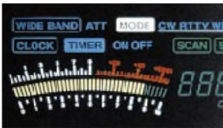
Die Anzeige der Feldstärke erfolgt ebenfalls im mehrfarbigen Display.
