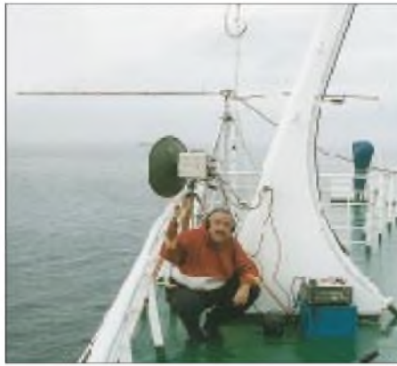
Rückfahrt: Nachdem sich der starke Wind auf dem Oberdeck der Fähre etwas gelegt hatte, ließ sich in JO34 auch die 10-GHz-Technik aufbauen. Auf dem Bild (oben) ist Matthias, DK5KK/MM, in „Arbeitsposition“ zu sehen. Die Montage der anderen Antennen geschah bei Fahrtantritt größtenteils in „Tarnstellung“ in liegender Position. Im unteren Bild ist der Standort der 13-El.-Yagi für 2 m (Hinfahrt) zu sehen, wobei in einigen Richtungen das Schiffsradar merkliche Störungen verursachte.
