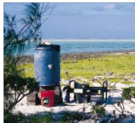
Der Generator. Das blaue Faß ersetzte den Tank, was einen unterbrechungsfreien Betrieb von 11 Tagen ermöglichte.
