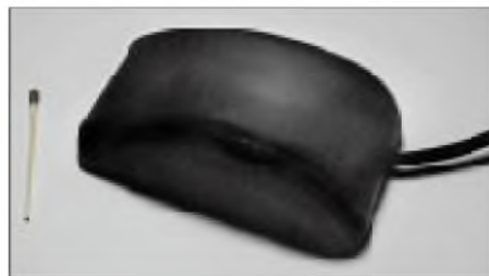
Bild 2: Der GPS-Empfänger wird magnetisch auf das Dach geheftet. Besitzer eines Fahrzeuges mit Aluminiumkarosserie (Audi) haben hier das Nachsehen.
