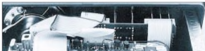
Bild 14: Hinter der Frontplatte befindet sich noch eine Montage-Leiterplatte für die Bedienelemente.
