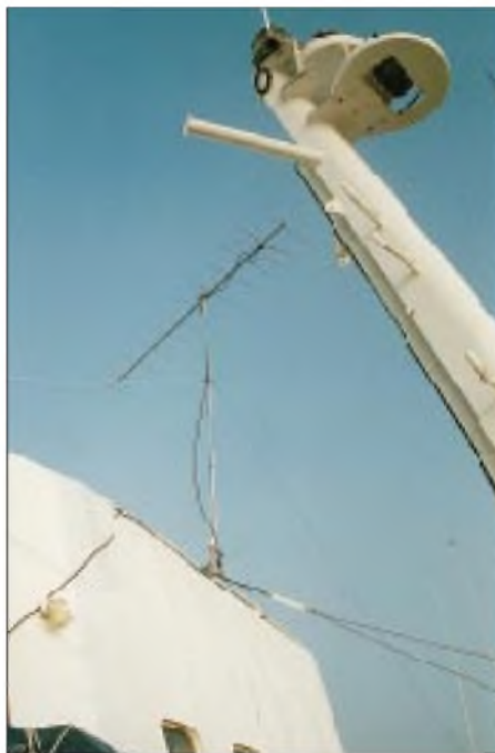
Rückfahrt: Nachdem sich der starke Wind auf dem Oberdeck der Fähre etwas gelegt hatte, ließ sich in JO34 auch die 10-GHz-Technik aufbauen. Auf dem Bild (oben) ist Matthias, DK5KK/MM, in „Arbeitsposition“ zu sehen. Die Montage der anderen Antennen geschah bei Fahrtantritt größtenteils in „Tarnstellung“ in liegender Position. Im unteren Bild ist der Standort der 13-El.-Yagi für 2 m (Hinfahrt) zu sehen, wobei in einigen Richtungen das Schiffsradar merkliche Störungen verursachte.
