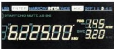
Das Display zeigt nicht nur die aktuelle Frequenz, sondern auch die numerischen Werte für PBS, Bandbreite und AGC an.
