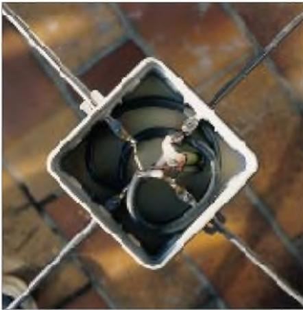
**Bild 5: Blick in die Anschlußdose des Strahlers der 2-Element-Yagi**
