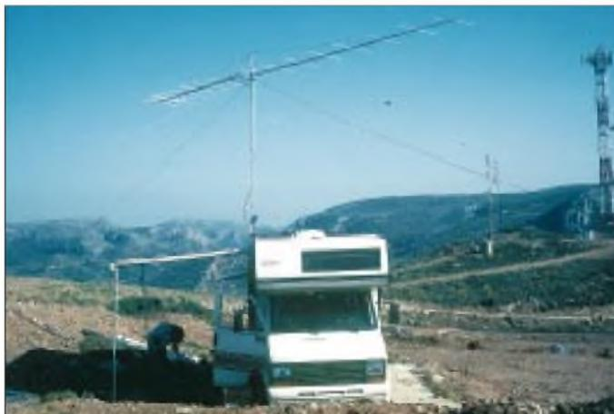
**Die 2-m-Meteorscatter-Station: Von hier aus gelangen mit 3CX800 an einer 17-Ele.-M<sup>2</sup> etliche QSOs über mehr als 2000 km.**
