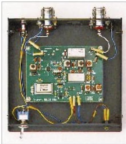
**Bild 4:** Ansicht des betriebsbereiten Empfangskonverters Foto: TO
