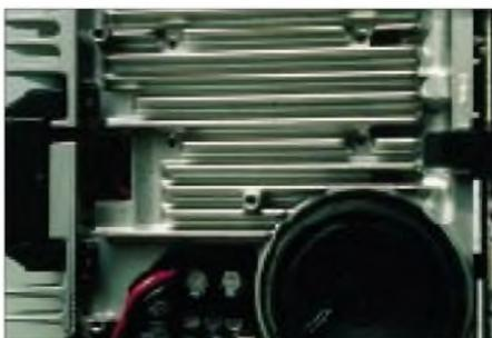
Die Gehäusekonstruktion sorgt für sichere Wärmeableitung.
