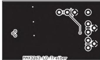
**Bild 10:** Die Leiterseite wird fast durchweg als Massefläche ausgeführt.
