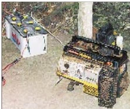
**Das Corpus delicti, das mir Kopfzerbrechen bereitete! Über den 12-V-Ausgang des Aggregats und Solarpanels wird die geliehene Batterie geladen.**
