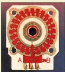
Mit Hilfe inkrementaler Geber in Form von Winkelencodern lassen sich die Funktionen analoger Drehsteller „digitalisieren“.
