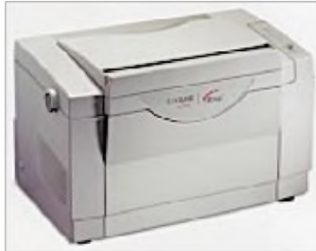
Bild 5: Für den Ausdruck des Platinenlayouts sollte ein Laserdrucker verwendet werden. Besitzt man selbst keinen, ist es gut, wenn man einen kennt, der einen kennt, der einen hat ...
