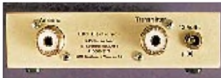
Bild 3: Rückseite des QRP-Tuners. Selbst die Betriebsspannungsbuchse ist eindeutig beschriftet.
