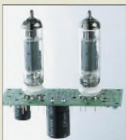
Je zwei PCL 86 in Gegentaktschaltung auf einer Leiterplatte
