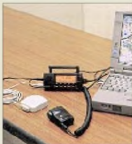
Navigationssystem: FM-Transceiver C 5750 mit Mikrophon, GPS-Antenne, Notebook und passender Software...
