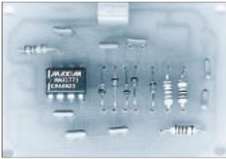
Bild 22: Die Spannungserzeugung für die APD-Spannung arbeitet als Schaltregler und kann Störstrahlungen erzeugen.
