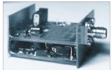
Bild 8: Die beiden Leiterplatten mit den ersten beiden Seitenteilen zusammengebaut; die HF-Verstärkerstufen sind noch nicht bestückt.
