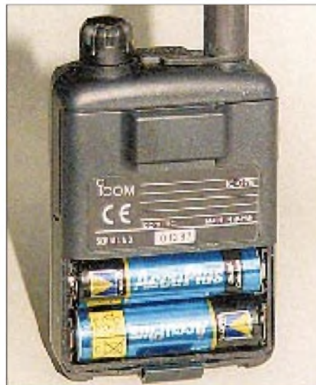
Zwei Mignonzellen genügen zur Stromversorgung.
