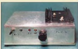
Der Transverter wurde zusammen mit einem zweistufigen Linearverstärker in einer Weißblechbox untergebracht.
