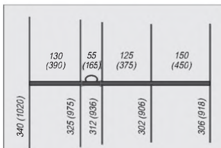
Bild 1: Dimensionierung einer 5-Element-Yagi für das 70-cm-Band (2-m-Band)
