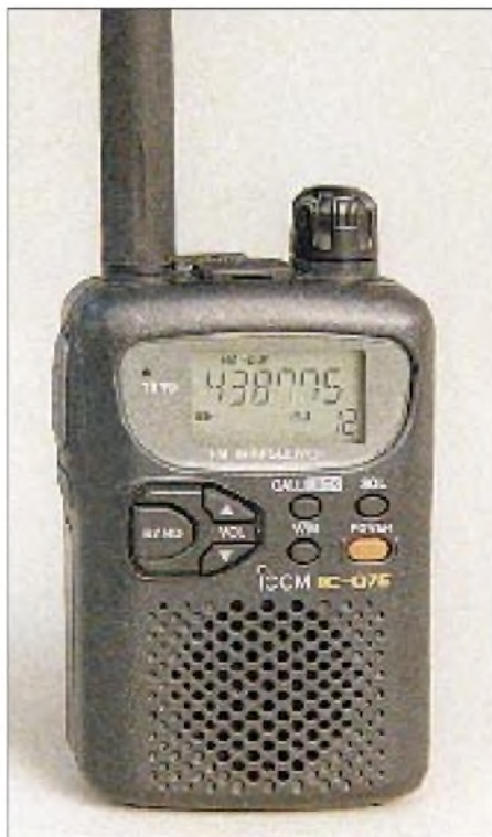
Mit nur neun Tasten und einem Drehschalter erfolgt die Bedienung des IC-Q7E.
