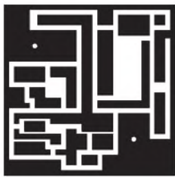
Bild 2: Leitungsführung der Oszillator-Platine (Videoverstärker und Oszillator), M = 1:1
