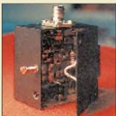
Das Bild zeigt, daß der Sender wirklich winzig ist. Der Deckel läßt sich bequem aufklappen, wodurch die Senderleiterplatte leicht zugänglich bleibt.
