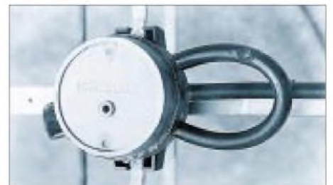
Bild 9: Anpassung/Symmetrierung für 70 cm mit einer Umwegleitung
