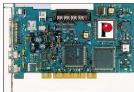
Die miroVIDEO DV 300 ermöglicht Videoschnitt komplett digital. Im Lieferumfang der Karte enthalten sind die Software miroVIDEO DVTools, miroINSTANT Video sowie die Schnittsoftware Adobe Premiere 4.2 LE zur Weiterbearbeitung des Videomaterials.
