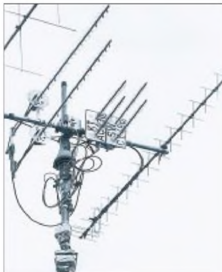
Bild 15: Am Ausleger des Elevationsrotors befestigte Vierer-Helix-Gruppe Fotos: Schmidtchens Phototeam
