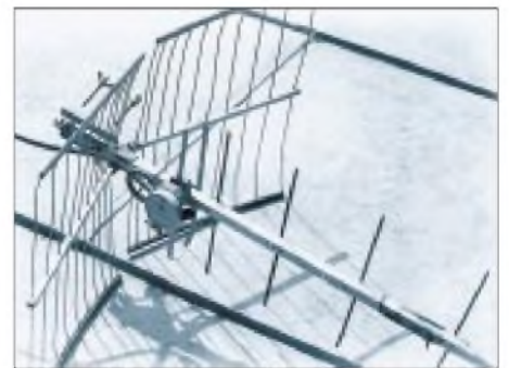
Bild 8: 70-cm-Yagi unter Verwendung von Eck- und Flächenreflektoren aus UHF-TV-Antennen für ein höheres Vor-/Rück-Verhältnis
