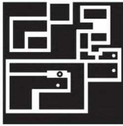
Bild 5: Leitungsführung der Verstärker-Platine (HF-Verstärker und Spannungsstabilisierung), M = 1:1
