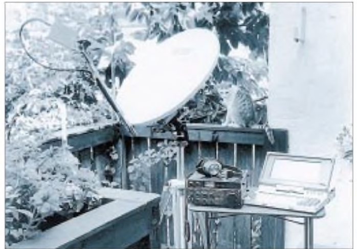
Bild 13: Versuchsaufbau zum Empfang der OSCAR-13-Bake auf 2400,664 MHz
