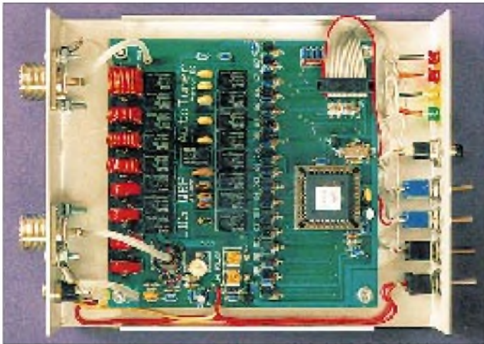
Bild 4: Innenansicht der QRP-Variante. V.l.n.r. auf der Leiterplatte die Ringkernspulen, die zugehörigen Relais, die Kondensatoren mit ihren Relais und die Relaisansteuerstufen; rechts der Prozessor. Unten links befindet sich die SWR-Meßschaltung, zwischen den Abstimmkondensatoren das 17. Relais für die high/low-Z-Umschaltung.
