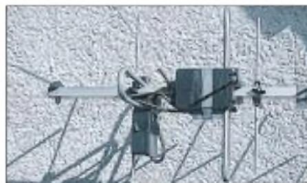
Bild 4: Elemente bei einer 70-cm-Kreuzyagi um  $\lambda/4$  auf dem Tragrohr versetzt
