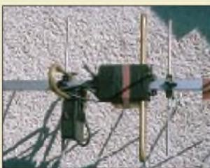
Eine Möglichkeit, zirkulare Polarisation zu erreichen, ist der Versatz der Elemente um  $\lambda/4$  auf dem Tragerohr
