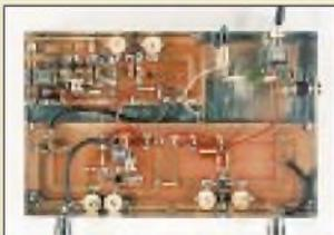
Die Transverterbaugruppen lassen sich auch zum Aufbau eines Empfangskonverters nutzen. Hier eine Version unter Verwendung von Scheibentrimmern und für eine ZF von 28 MHz (101-MHz-Quarz)
