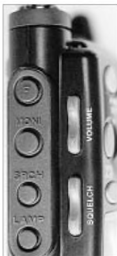
Beim DJ-X10 erfolgt die Einstellung von Lautstärke und Rauschsperrung über Wipptasten.
