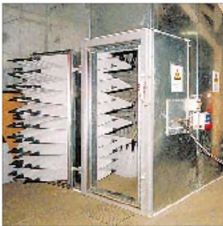
Der Eingangsbereich der 8 m x 5 m x 4 m messenden Absorberhalle. Am rechten Türrahmen die Senderfernsteuerung, die bei Prüfbetrieb die Hochfrequenz beim Öffnen der Tür abschaltet. Weiter rechts das Anschlußpanel mit Kabelzuführung zum Verstärkerraum.
