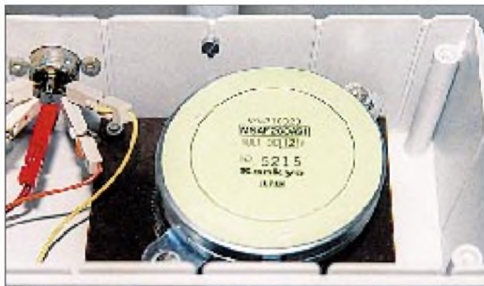
Bild 2: Der Schrittmotor findet in einer Kunststoffbox Platz.
