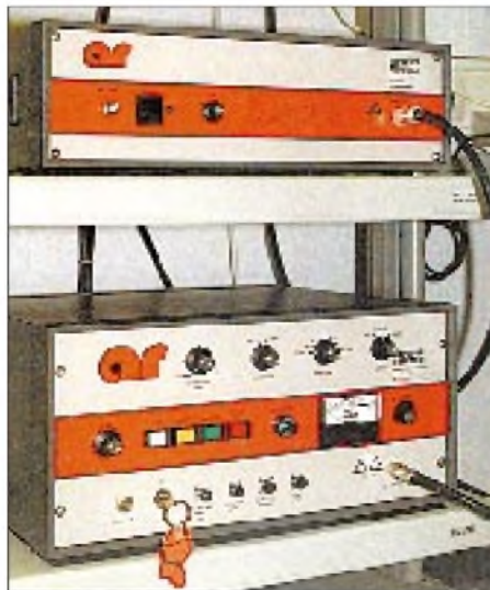
Hochfrequenzverstärker für den Bereich 10 kHz bis 1000 MHz mit einer garantierten Ausgangsleistung von 100 W an jeder Last und bei jedem Stehwellenverhältnis ohne Reduzierung oder Abschaltung der Ausgangsleistung Fotos: Autor
