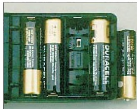
Im Batteriefach des IC-R10 entscheidet ein Schalter darüber, ob geladen werden kann oder nicht.
