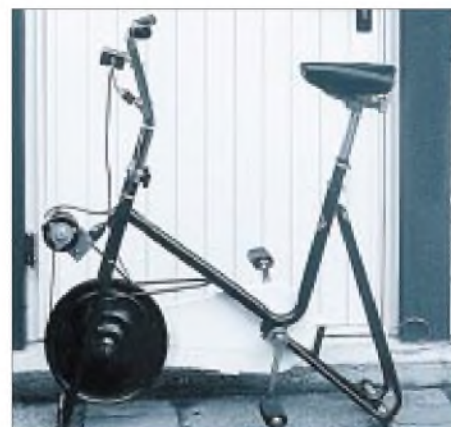
Der zum Trekkurbelgenerator umgebaute Hometrainer Foto: DJ3RW
