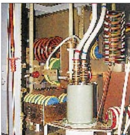
Wassergekühlte Endstufenröhre des Mittelwellensenders Sölvesborg ▲
