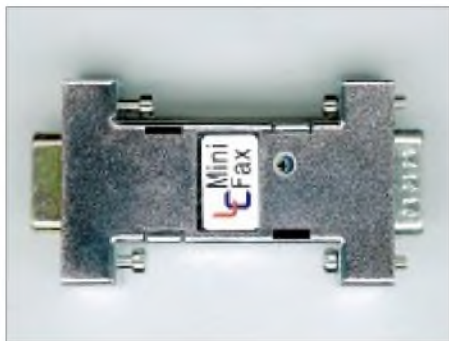
Das preiswerte HamComm-Modem – funktioniert bei RTTY, AMTOR, Fax und SSTV, auch ohne Soundkarte (Vertrieb u.a. Fa. Hegewald). Foto: DL1UU
