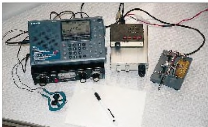
Der AT-909 eignet sich auch gut als Empfänger für die QRP-Station. Neben dem AT-909 sind der MFJ-Tuner 945, der QRP-Transceiver T40P und der Superkeyer II zu sehen. Zum sauberen Mithören des Sendesignals muß die Empfangsantenne während des Sendens vom AT-909 abgetrennt werden.
