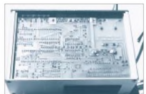
Bild 5: Der Einbau der Hauptplatine erfolgt in ein stabiles Metallgehäuse.
