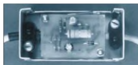
Bild 4: Innenleben des Ladegerätes für das Handy VX1R. Der Spannungsregler wird von der Platine verdeckt.
