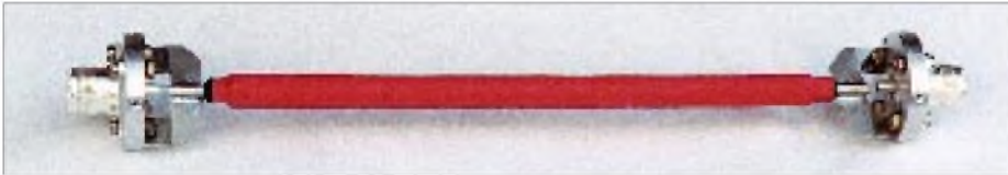
Bild 8: Fertig montierte Innenleitung der Mantelwellensperre
