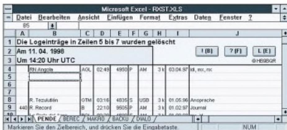
Bild 11: Soeben wurden durch Mausklick auf L (oder Ctrl E) drei Logeinträge gelöscht. Dabei muß einfach je mindestens eine Zelle der zu löschenden Logzeile aktiviert werden (z.B. A5:A7, E5:J7 oder 5:7)
