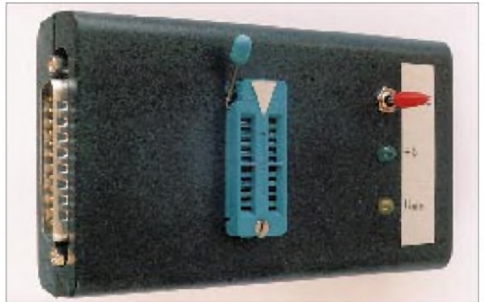
Bild 5: Blick auf das geschlossene Gerät. Links die Sub-D-Buchse, in der Mitte die 20pol-Textool-Fassung. Rechts oben der Schalter S1 für die Betriebsspannung, darunter die Anzeige +5 V, unten die LED für die Eingangsspannung.
