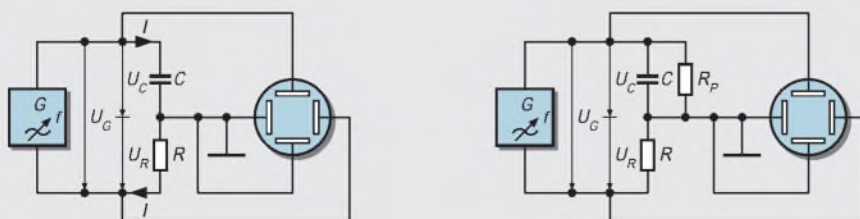
Bild 20: Mit einer Sinusspannung an einer RC-Reihenschaltung bekommt man auf Grund der 90-Grad-Phasenverschiebung zwischen Strom und Spannung in der X-Y-Darstellung auf dem Bildschirm einen Kreis.
