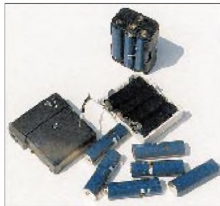
Die vier Zustände auf einem Bild: links die Akkukassette von einem schnurlosen Telefon (schwarz), rechts eine geöffnete Akku-Kassette mit vier Mignon-NiCd-Zellen und den Verbindungsstegen. Unten sechs für gut befundene, nun getrennte Einzelzellen; oben ein neu zusammengestellter Akkupack mit sechs Zellen Foto: DJ3RW
