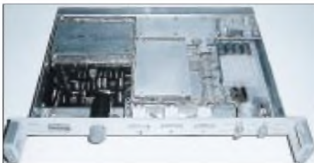
Bild 2: TV-Frequenznormal. Links ist der Tuner mit der Abstimmereinheit und digitaler Kanal-anzeige angeordnet. Das eigentliche Frequenznormal steckt im geschirmten Kasten in der Mitte. Die Ausgangspufferschaltung (hinten) entspricht der Technik der früheren DCF-77-Einheit aus Bild 1.
