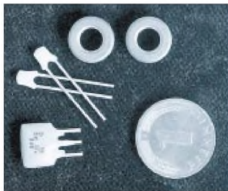
Bild 18: Komponenten für einen Keramikfilter-Bandpaß: SFE 7,02 MC2, Ringkerne FT37-77 und keramische Kondensatoren
