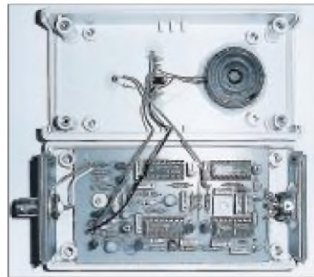
Bild 3: Eine recht kompakte Version des TV-Frequenznormals. Es wird bei Bedarf an einen dafür vorgesehenen Tuner angesteckt. Leuchtdiode und „Piepser“ im Deckel signalisieren den „ordnungsgemäßen“ Zustand.
