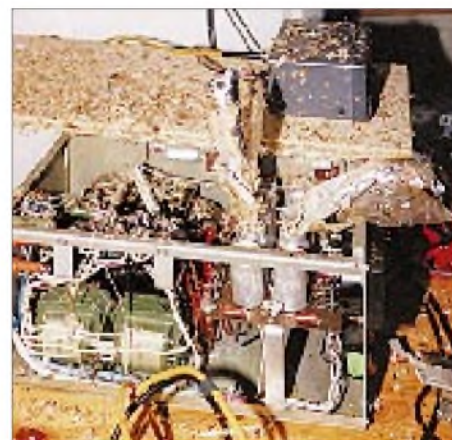
„Endstufenexplosion“. Die Papierfetzen aus den Elektrolytkondensatoren verteilen sich durchs halbe Shack. Fotos: DL7UFR
