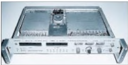
Bild 1: Nur durch enormen Aufwand läßt sich ein präzises Frequenznormal mit dem Langwellensender DCF-77 aufbauen. Es besteht aus Empfänger (links), TCXO (Mitte vorn), digitalem Frequenzdiskriminator (rechts) und acht Ausgangspuffern (rechts hinten). „Abfallprodukt“ ist die genaue amtliche Zeit.
