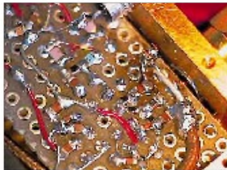
Bild 2: Experimentalaufbau (Leiterplatten- rückseite) des IQ-Mischers
