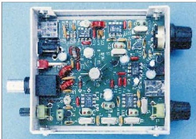
Der SST kommt völlig ohne interne Verdrahtung aus; sämtliche Bauelemente befinden sich auf der Leiterplatte.
