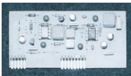
Bild 5: Die Phono-Entzerrer-Verstärker-Karten sind aufsteckbar ausgeführt.
