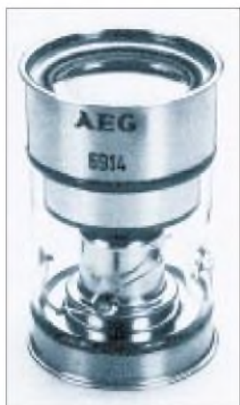
Bild 4: Der Infrarot- bildwandler der AEG ist eine Diode mit elektro- statischer Fokussierung.
