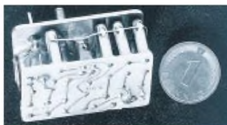
Bild 9: Offenes KVG-Filter (achtpoliges Antennen-Quarzfilter)
