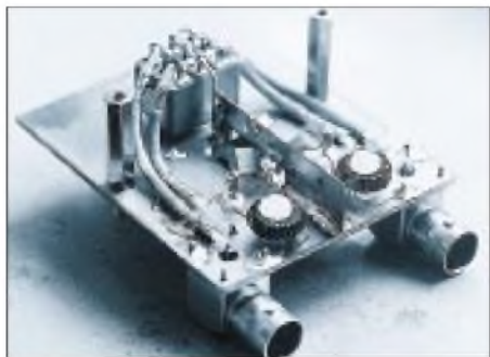
Bild 13: Keramik-Vorfilter-Versuchsaufbau von HB9JNH/AFR Fotos: DJ2EV
