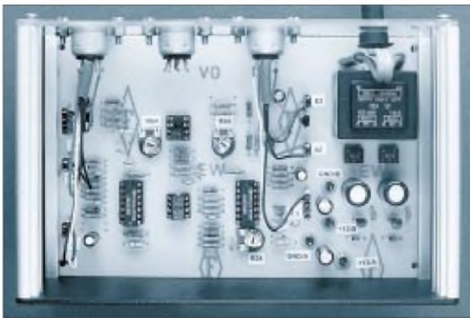
Bild 13: Blick von oben in das komplette Gerät. Rechts oben der Netztransformator, darunter die übrigen Bauelemente für die Stromversorgung. In der linken Hälfte sind die beiden acht-poligen IC-Fassungen mit den Optokopplern sichtbar.
