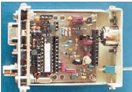
Der „CW-Assistent“ ist eine mikrocontrollergesteuerte Schaltung, die die Steuerung von PTT und Mithörton bei der Abwicklung von CW-Ortsrunden und Lehrgängen in der Betriebsart F2A unterstützt. Auch Festtexte sind programmierbar und erleichtern die Betriebsabwicklung. Foto: DF9IV
