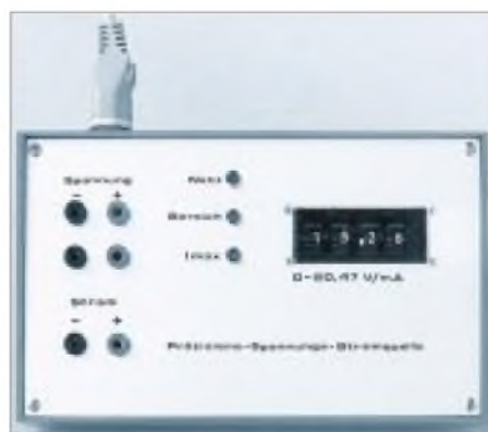
Bild 4: Die Eingabe erfolgt über BCD-Codierschalter mit Hebelübersetzung. Foto: Autoren
