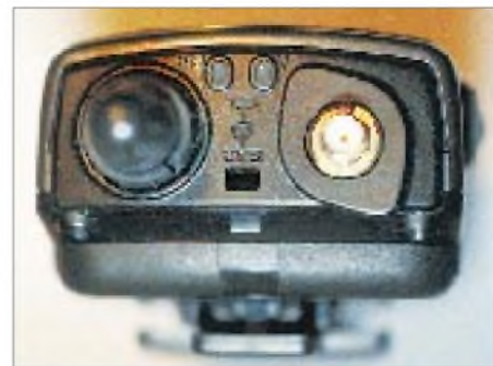
Obligatorisch: Die SMA-Antennenbuchse kommt bei allen neuen Handfunkgeräten zum Einsatz.
