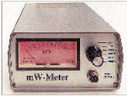
Bild 10: Ansicht des betriebsbereiten Milli wattmeters für Diodendetektoren Fotos: DJ8ES
