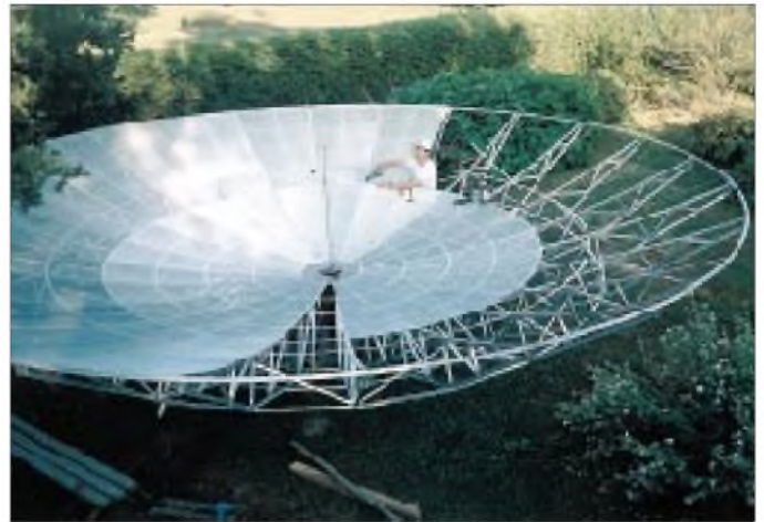
Der 8 m große EME-Spiegel für 70 cm bei Eino, OH2DG, in KP30CK. Zum Einsatz kommen weiterhin ein FT-736, HB PHEMT LNA SPF-1476, MGF1302 und 500-W-Feed. Eino ist über oh2dg@sral.fi zu erreichen. Foto via DK3WG
