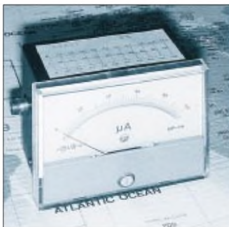
Bild 17: Ansicht des thermischen Leistungsmessers (die Eichkurve wurde oben aufgeklebt) Foto: DL2AVH
