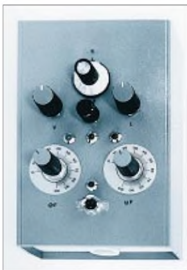
Bild 8: Das fertige Gerät. Die Linse bzw. der Plastikfühler für Platinen wird vorn eingesetzt.
