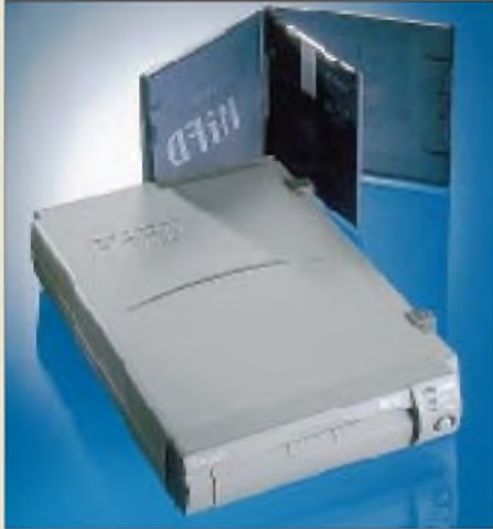
Mit dem HiFD-Drive lassen sich 200-MB-Floppy-Disks lesen und beschreiben. Entscheidendes Plus: Die Laufwerke sind abwärtskompatibel zur heutigen Standard-Floppy.
