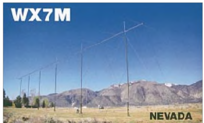
Die 20-m-Yagi von WX7M hat einen berechneten Gewinn von über 19 dBi, ein Vor/Rück-Verhältnis von etwa 34 dB und ein SWR unter 1,3 – jeweils über das gesamte Band. Der Erhebungswinkel beträgt 14°.
