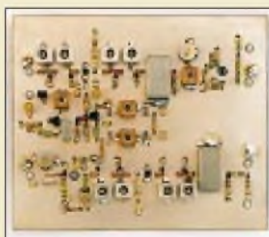
Der Transverter wird auf einer doppel-seitig kaschierten Platine aufgebaut, deren Oberseite der Schirmung dient. Foto: DJ8ES
